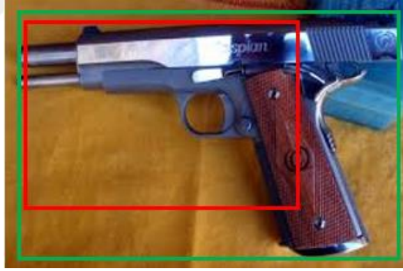
Şekil 2.19: Görüntü Kesit Örtüşmesi (IoU).
