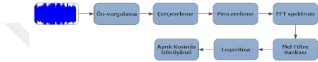
Şekil 3.9. Mel Frekans Kepstral Sayıları algoritmasının diyagramı
