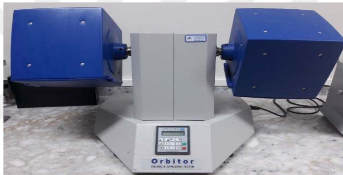
Figure 3.5. The ICI pilling box tester
