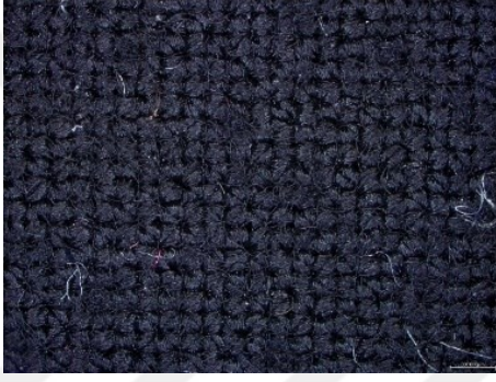
Şekil 4.15. Boncuklanma testi sonrası işlemsiz ve PVPA uygulanmış K-5 kumaşının yüzey görüntüsü A) İşlemsiz B) 40 g/l PVPA uygulanmış
