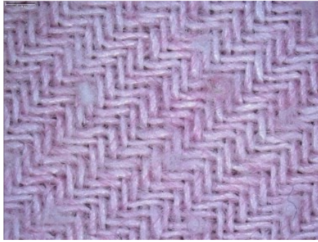
Şekil 4.16. Boncuklanma testi sonrası işlemsiz ve PVP uygulanmış K-1 kumaşının yüzey görüntüsü A) İşlemsiz B) 30 g/l PVP uygulanmış
