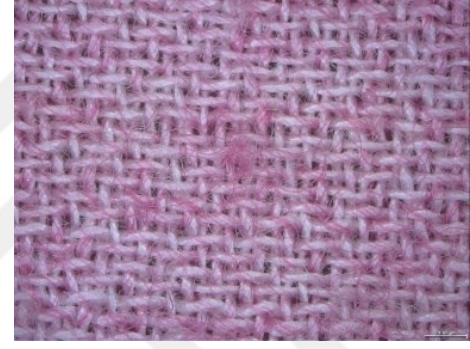
Şekil 4.12. Boncuklanma testi sonrası işlemsiz ve PVPA uygulanmış K-2 kumaşının yüzey görüntüsü A) İşlemsiz B) 40 g/l PVPA uygulanmış
