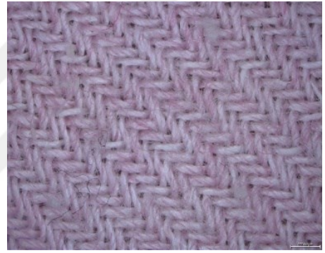
Şekil 4.6. Boncuklanma testi sonrası işlemsiz ve PVCL uygulanmış K-1 kumaşının yüzey görüntüsü A) İşlemsiz B) 40 g/l PVCL uygulanmış
