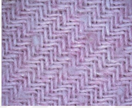
Şekil 4.21. Boncuklanma testi sonrası işlemsiz ve PVTAZ uygulanmış K-1 kumaşının yüzey görüntüsü A) İşlemsiz B) 10 g/l PVTAZ uygulanmış
