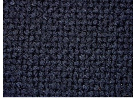
Şekil 4.5. Boncuklanma testi sonrası işlemsiz ve PVIM uygulanmış K-5 kumaşının yüzey görüntüsü A) İşlemsiz B) 50 g/l PVIM uygulanmış
