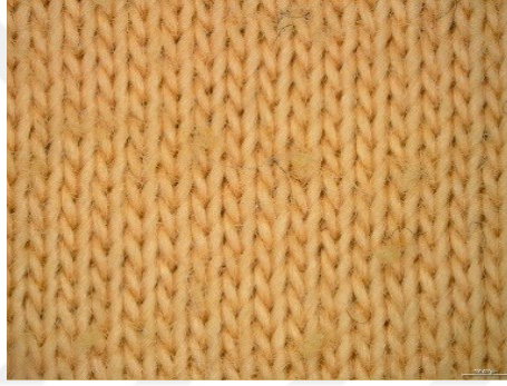
Şekil 4.18. Boncuklanma testi sonrası işlemsiz ve PVP uygulanmış K-3 kumaşının yüzey görüntüsü A) İşlemsiz B) 30 g/l PVP uygulanmış
