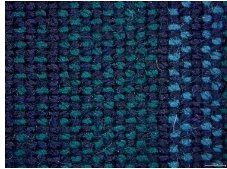
Şekil 4.4. Boncuklanma testi sonrası işlemsiz ve PVIM uygulanmış K-4 kumaşının yüzey görüntüsü A) İşlemsiz B) 50 g/l PVIM uygulanmış
