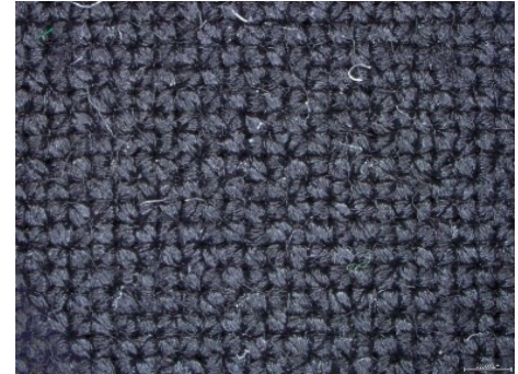
Şekil 4.25. Boncuklanma testi sonrası işlemsiz ve PVTAZ uygulanmış K-5 kumaşının yüzey görüntüsü A) İşlemsiz B) 10 g/l PVTAZ uygulanmış
