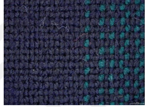
Şekil 4.24. Boncuklanma testi sonrası işlemsiz ve PVTAZ uygulanmış K-4 kumaşının yüzey görüntüsü A) İşlemsiz B) 10 g/l PVTAZ uygulanmış
