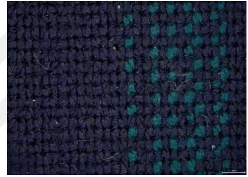
Şekil 4.9. Boncuklanma testi sonrası işlemsiz ve PVCL uygulanmış K-4 kumaşının yüzey görüntüsü A) İşlemsiz B) 40 g/l PVCL uygulanmış
