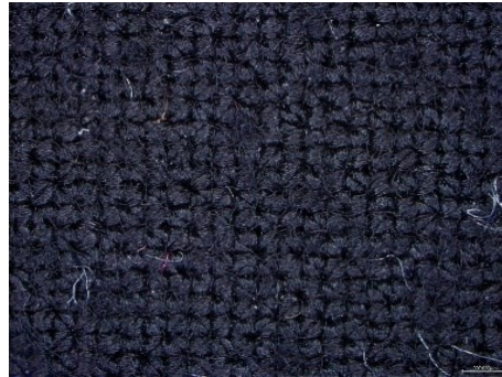
Şekil 4.25. Boncuklanma testi sonrası işlemsiz ve PVTAZ uygulanmış K-5 kumaşının yüzey görüntüsü A) İşlemsiz B) 10 g/l PVTAZ uygulanmış
