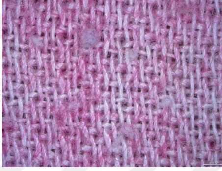
Şekil 4.12. Boncuklanma testi sonrası işlemsiz ve PVPA uygulanmış K-2 kumaşının yüzey görüntüsü A) İşlemsiz B) 40 g/l PVPA uygulanmış
