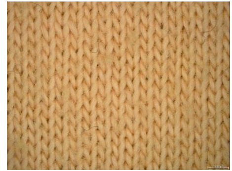
Şekil 4.13. Boncuklanma testi sonrası işlemsiz ve PVPA uygulanmış K-3 kumaşının yüzey görüntüsü A) İşlemsiz B) 40 g/l PVPA uygulanmış
