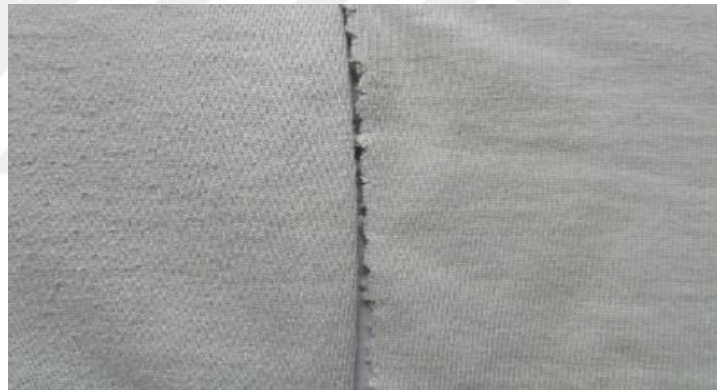
Şekil 2.7. İşlemsiz ve anti-boncuklanma kimyasalı uygulanmış kumaşların görüntüsü A) İşlemsiz B) Kimyasal uygulandıktan sonra
