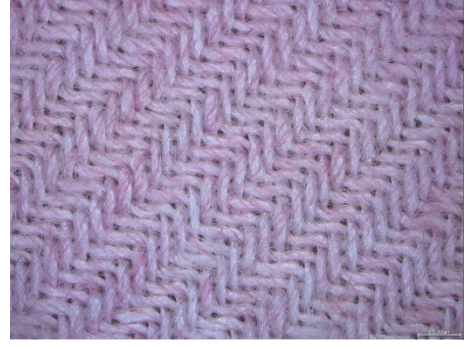
Şekil 4.26. İşlemsiz ve PVPA uygulanmış K-1 kumaşının yüzey görüntülerinin sararma açısından kıyaslanması A) İşlemsiz B) 40 g/l PVPA uygulanmış
