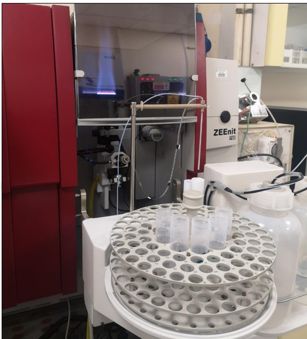
Fig.15. Atomic Absorbtion Spectrophotometer (Zeenit 700 P, Analytik Jena AG, Germany)
