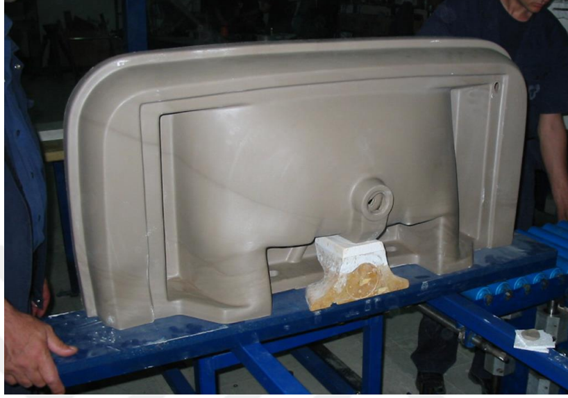
Fotoğraf 36: Kalıptan Yarı Ürün Alma Ceketİ
