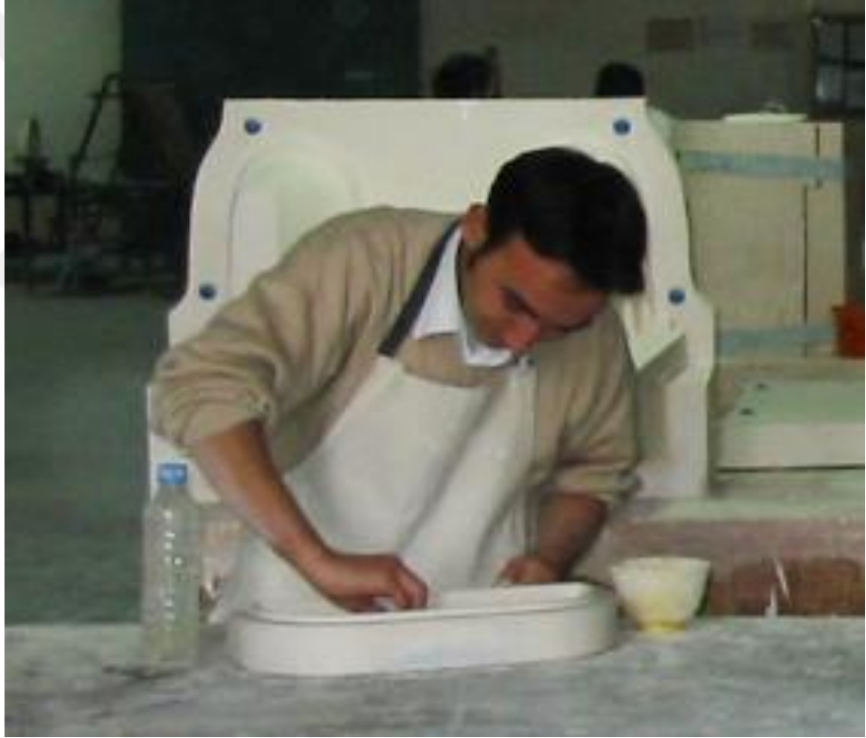
Fotoğraf 16: Modelci tarafından rezervuar kapağı modeli yapımı
