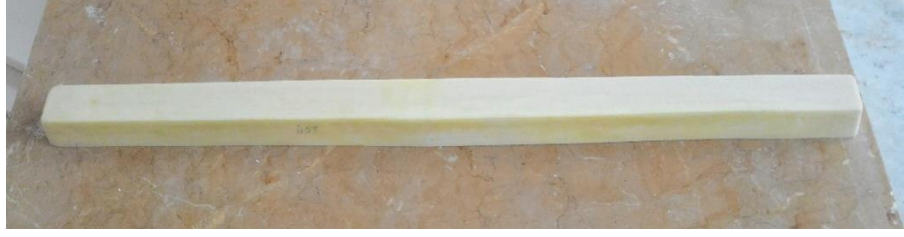
Fotoğraf 41: Poliüretan malzemeden yapılmış düzeltme mastarı
