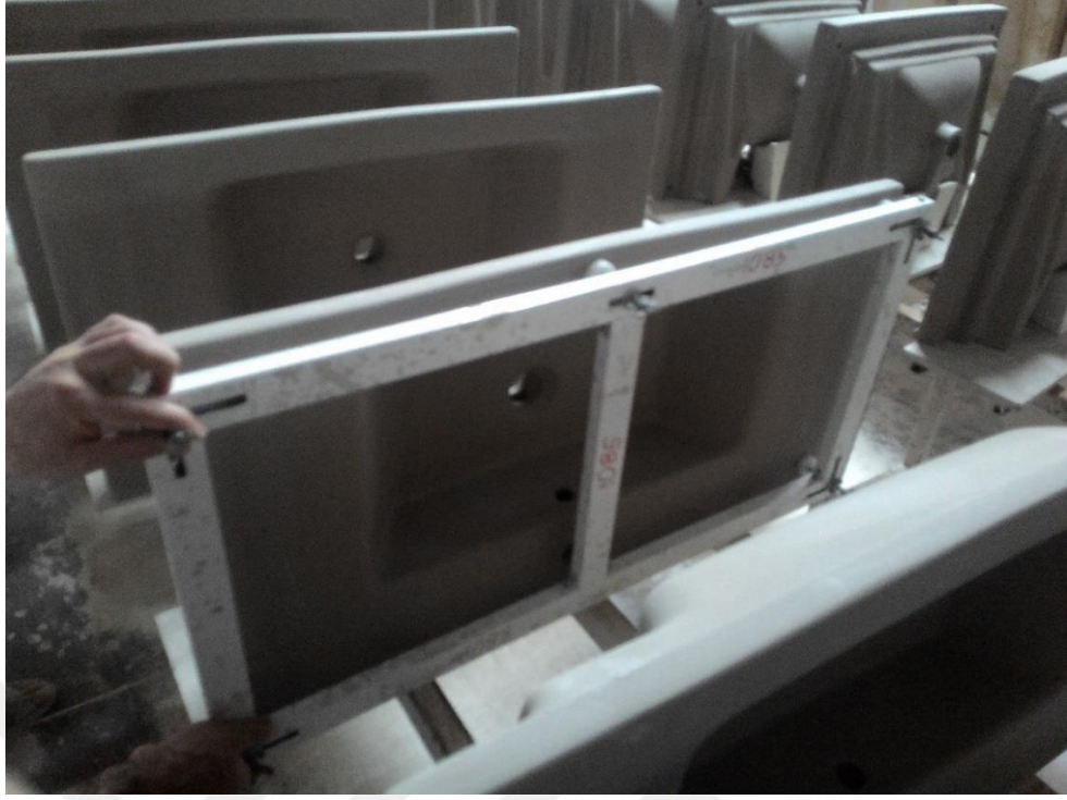
Fotoğraf 61: Seri üretimde kontrol profilinin kullanılması
