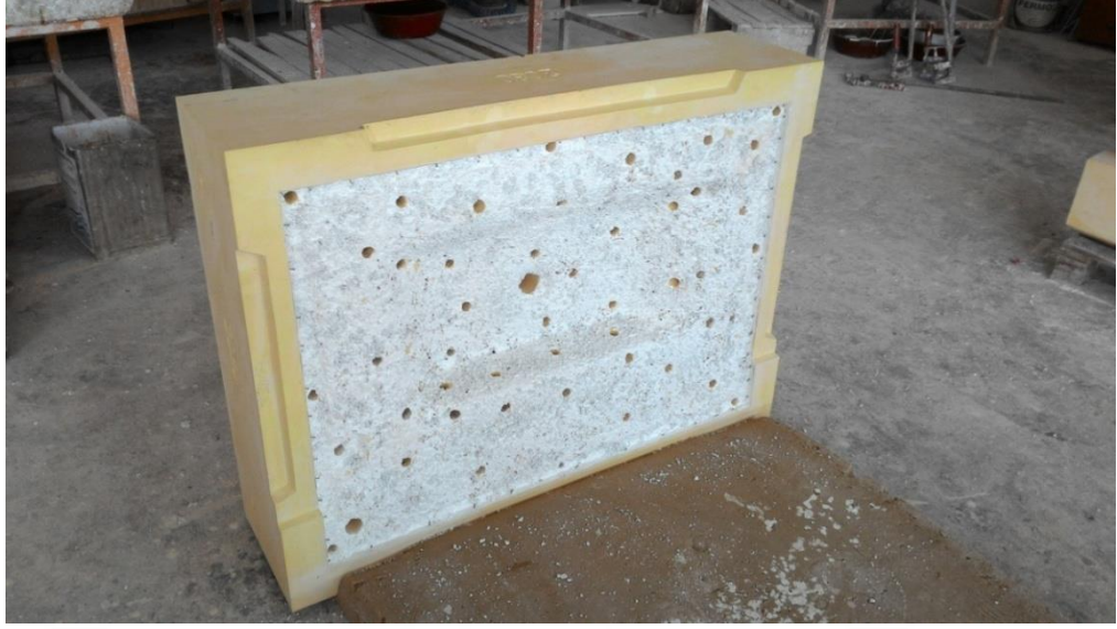
Fotoğraf 47: Silis kumu ve reçine sürülmüş ana kalıp parçası
