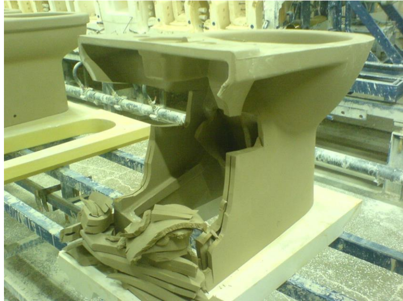
Fotoğraf 15: Yarı üründe et kalınlıklarının kontrol edilmesi
