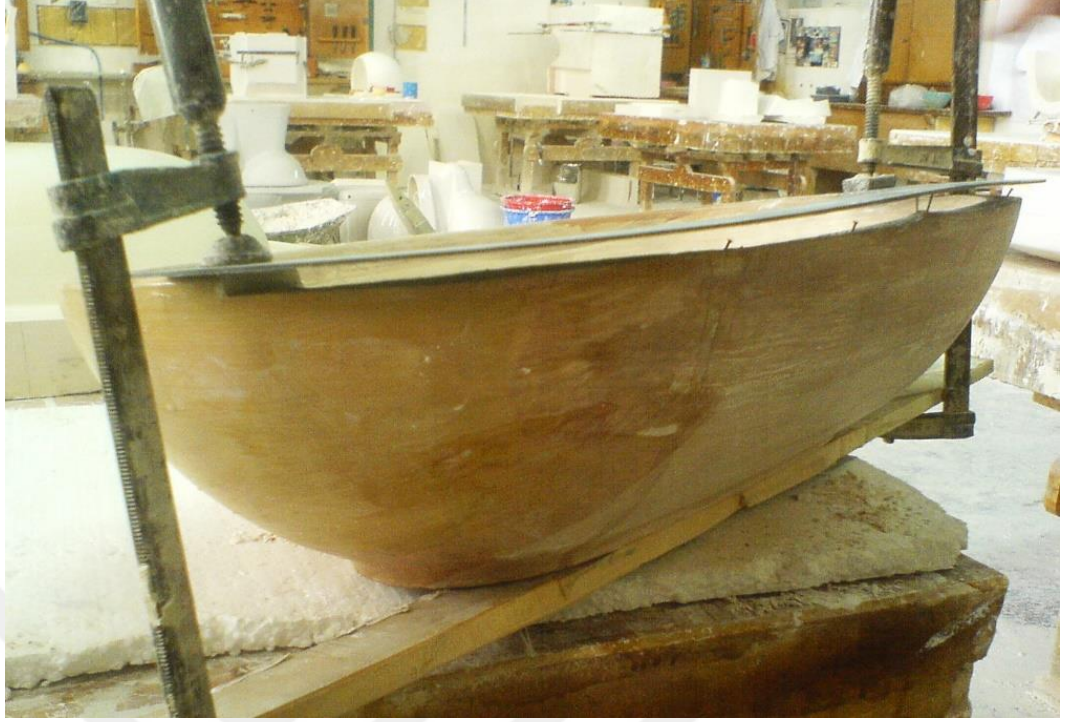
Fotoğraf 33: Lavabo modelinde üst bant yüzeyine tadilat yapılması
