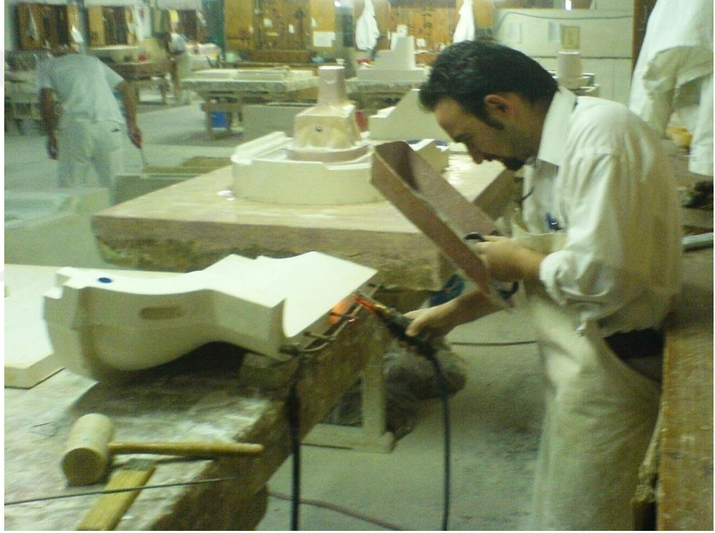
Fotoğraf 50: İşletme kalıbına tadilat uygulaması
