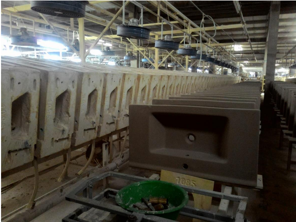
Fotoğraf 63: Deformasyonları giderilmiş uygulama ürününün seri üretimi
