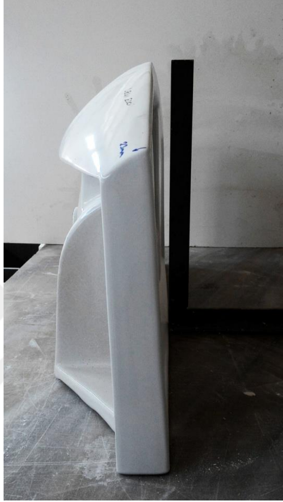
Fotoğraf 29: Gönye ile geriye eğilme kontrolü yapılan lavabo
