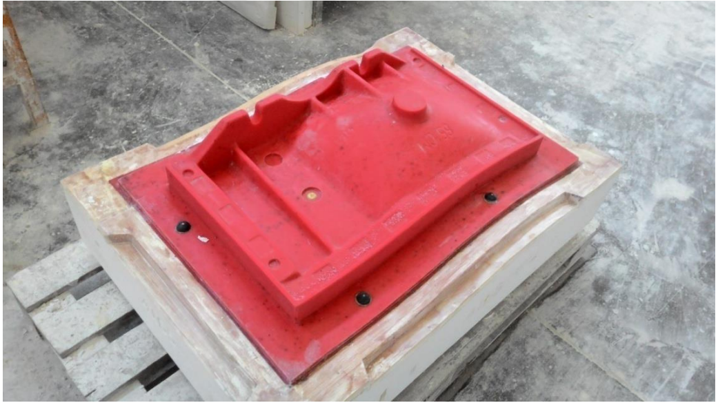
Fotoğraf 49: Teksir alçısı ve silikon malzemedan oluşan ana kalıp parçası
