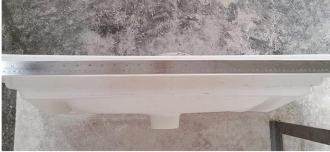
Fotoğraf 56: Uygulama ürünü ön bant yüzeyinin çelik cetvel ile kontrolü
