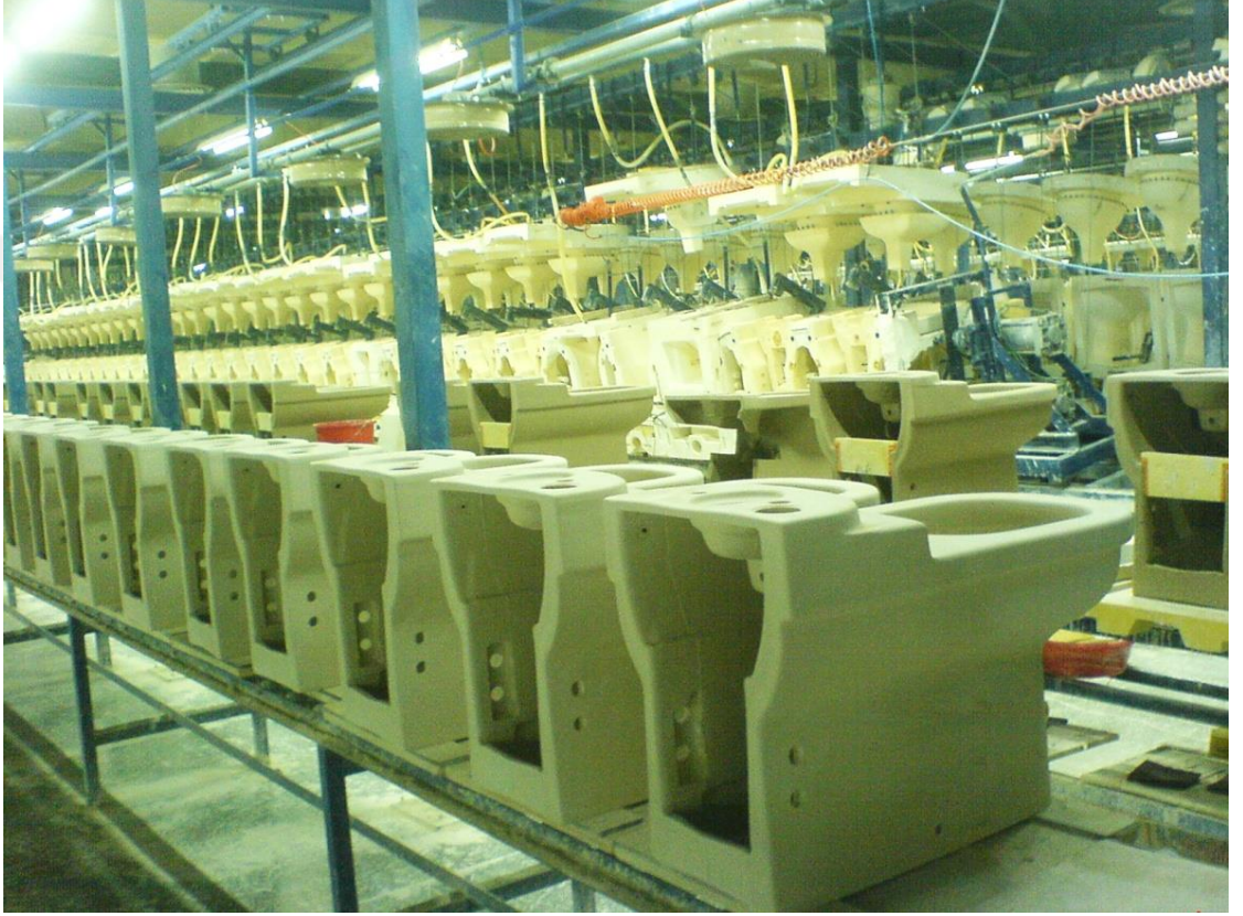
Fotoğraf 12: Mekanize döküm sisteminde şekillendirilen klozetler
