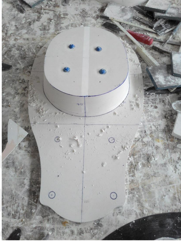
Fotoğraf 13: Alçı kullanılarak şekillendirilen klozet modeli
