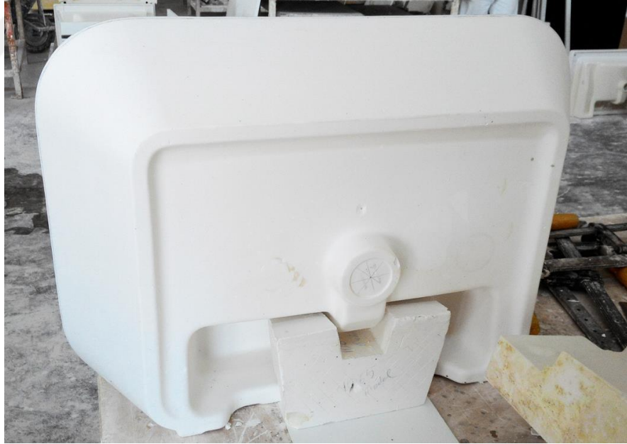
Fotoğraf 43: Lavabo modeli üzerinden pişme bomzesinin oluşturulması
