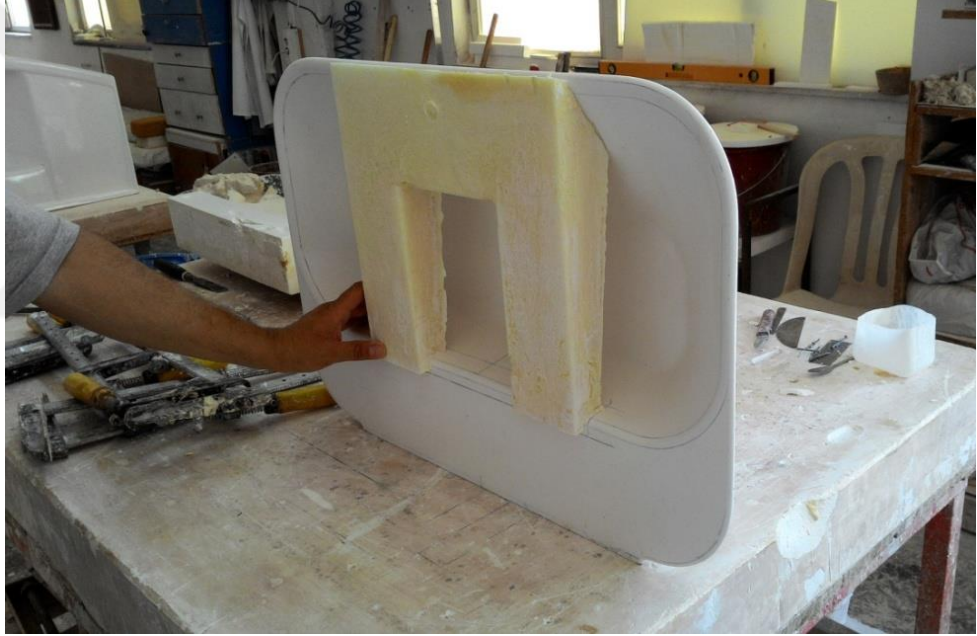
Fotoğraf 38: Lavabo modeli üzerinden poliüretan desteğin ayarlanması
