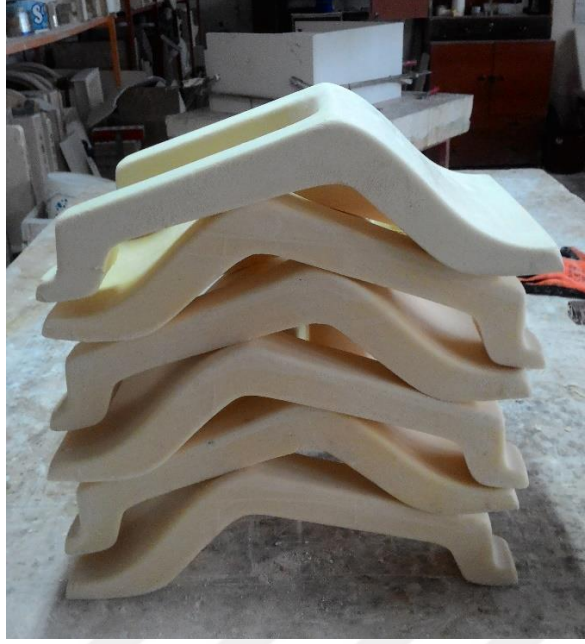
Fotoğraf 34: Seri üretimde kullanılmak üzere çoğaltılmış poliüretan destekler
