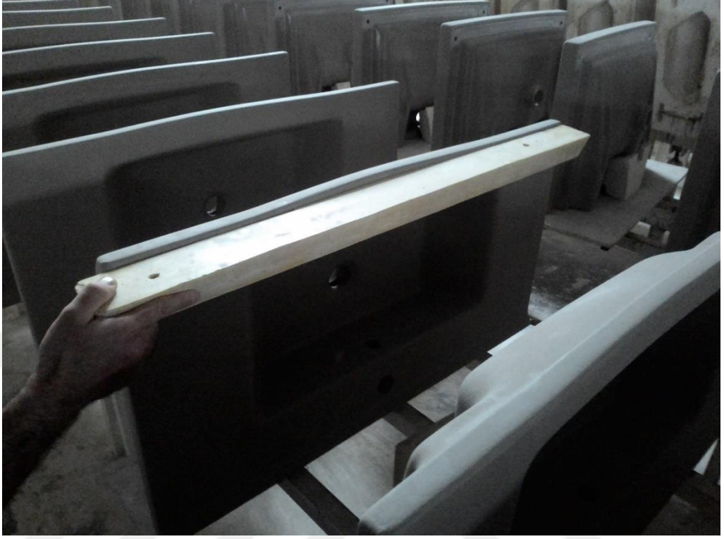
Fotoğraf 60: Seri üretimde poliüretan düzeltme mastarının uygulanması
