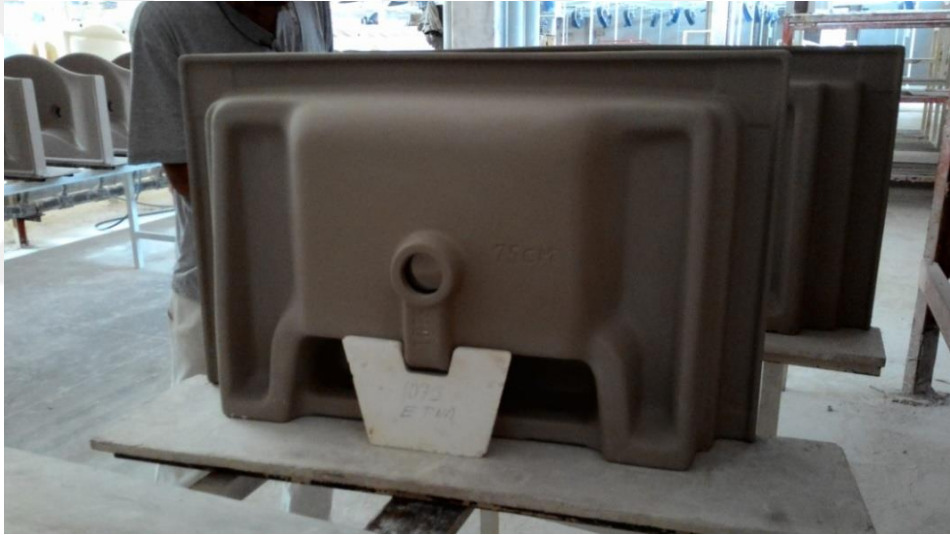
Fotoğraf 40: Çökmeyi önlemek için hazne arkasında kullanılan alçı destek
