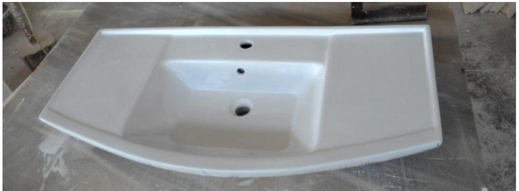
Fotoğraf 44: Deformasyonları giderilerek olumlu sonuçlanmış deneme ürün
