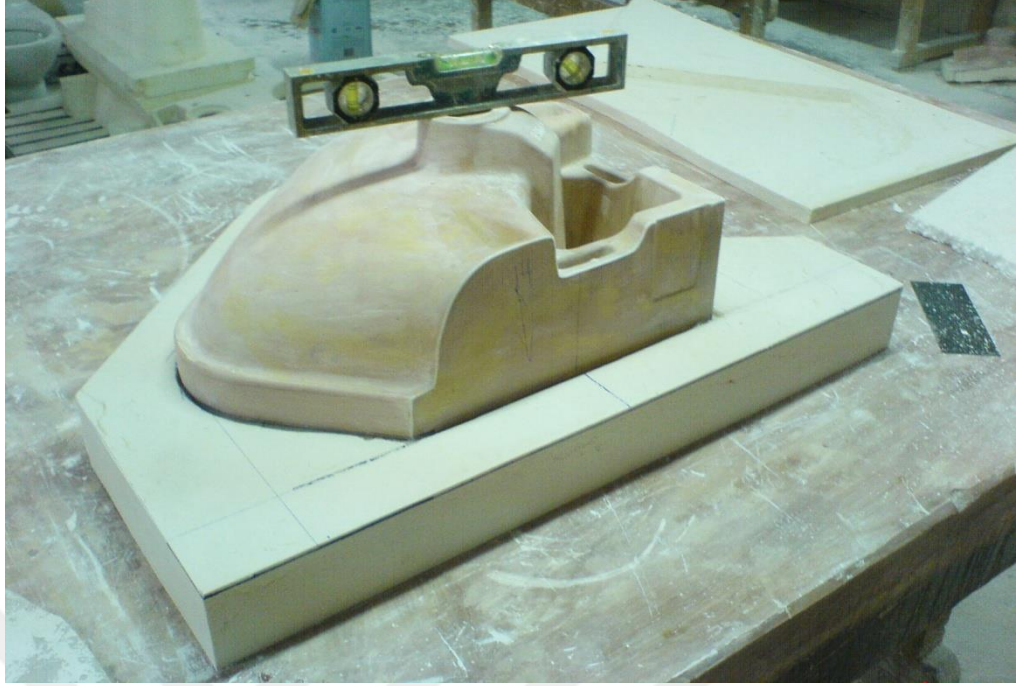
Fotoğraf 24: Model kalıp yapımına başlanmış köşe lavabo modeli
