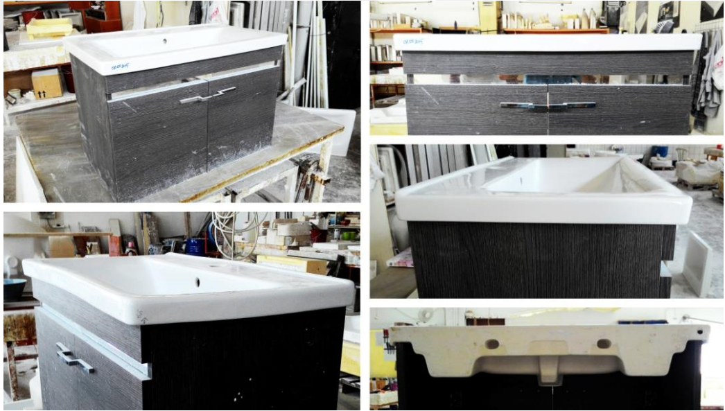
Fotoğraf 30: Lavabo ve dolap uyumunun kontrolü
