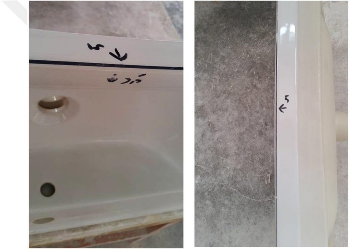
Fotoğraf 55: Uygulama ürünü olan dörtgen lavaboda çökme oranları
