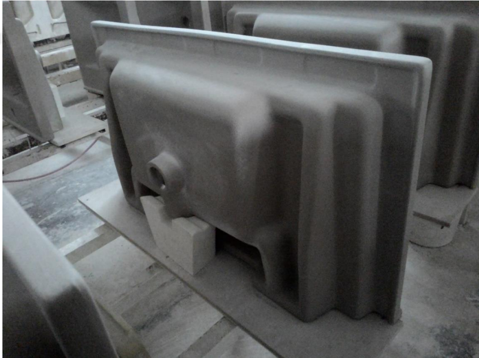
Fotoğraf 62: Seri üretimde alçı desteğin su taşma kanalında kullanılması
