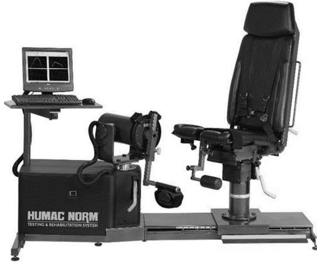
Şekil 3.1. İzokinetik Dinamometre (Humac Norm, CSMI, USA).
