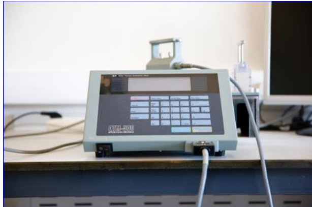
Şekil 27: Isı İletim Katsayısının Tespitinde Kullanılan QTM-500 Cihazı
