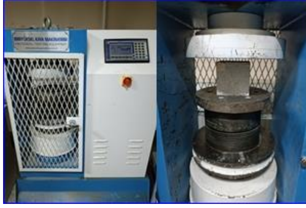
Şekil 31: SAKHB Numunelerinin Basınç Dayanımı Tespitinin Gerçekleştirilme Süreci
