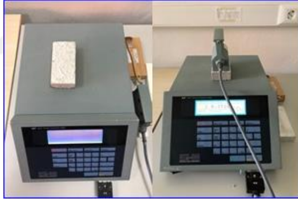
Şekil 29: Isı İletim Katsayısının Tespitinde Deneyin Gerçekleşme Görüntüsü
