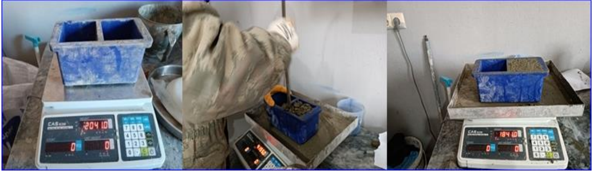
Şekil 25: Taze Beton Birim Hacim Ağırlıklarının Tespitine Ait Görüntüler
