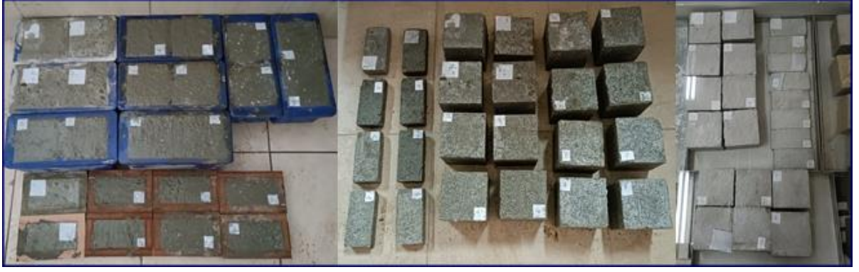
Şekil 24: SAKHB Numunelerin Kalıplardan Çıkarılma ve Kürlenme Süreci
