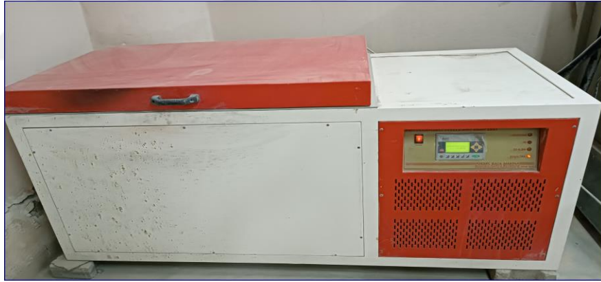
Şekil 32: SAKHB Numunelerinin Donma-Çözülme İşlemine Maruz Kalma Süreci
