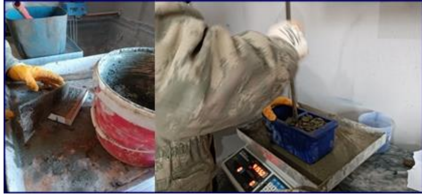
Şekil 23: SAKHB Numunelerinin Kalıplara Yerleştirilmesi
