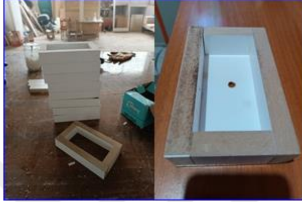
Şekil 28: Isı İletim Katsayısının Tespiti İçin Hazırlanan Numune Kalıpları
