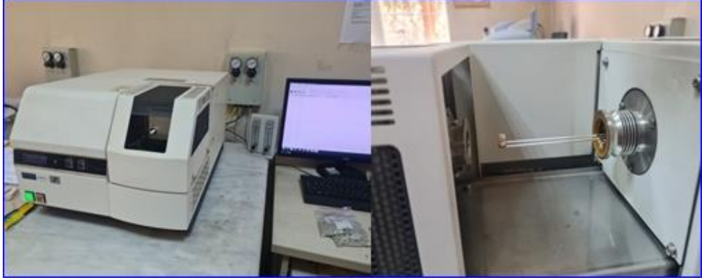
Şekil 35: SAKHB Numunelerinin TGA/DTG Analizinde Kullanılan Cihaz
