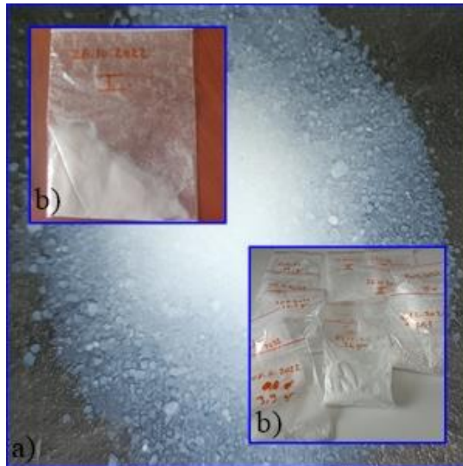
Şekil 15: (a) Silika Aerogel ve (b) Sızdırmaz Poşetlerde Saklanması
