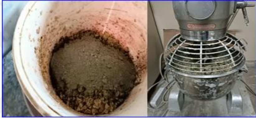
Şekil 22: SAKHB Numunelerinin Hazırlanma Aşamaları
