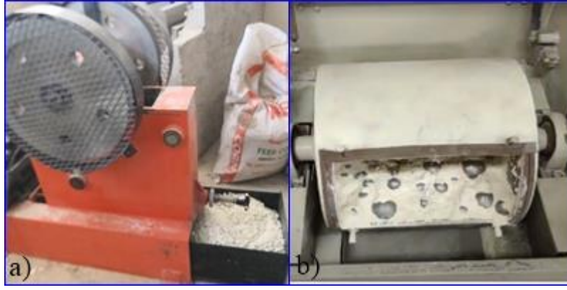
Şekil 10: BBT'nın (a) Kırılmış ve (b) Toz Haline Getirilmiş Hali
