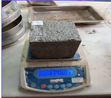
Şekil 26: Sertleşmiş Beton Birim Hacim Ağırlıklarının Tespitine Ait Görüntü
