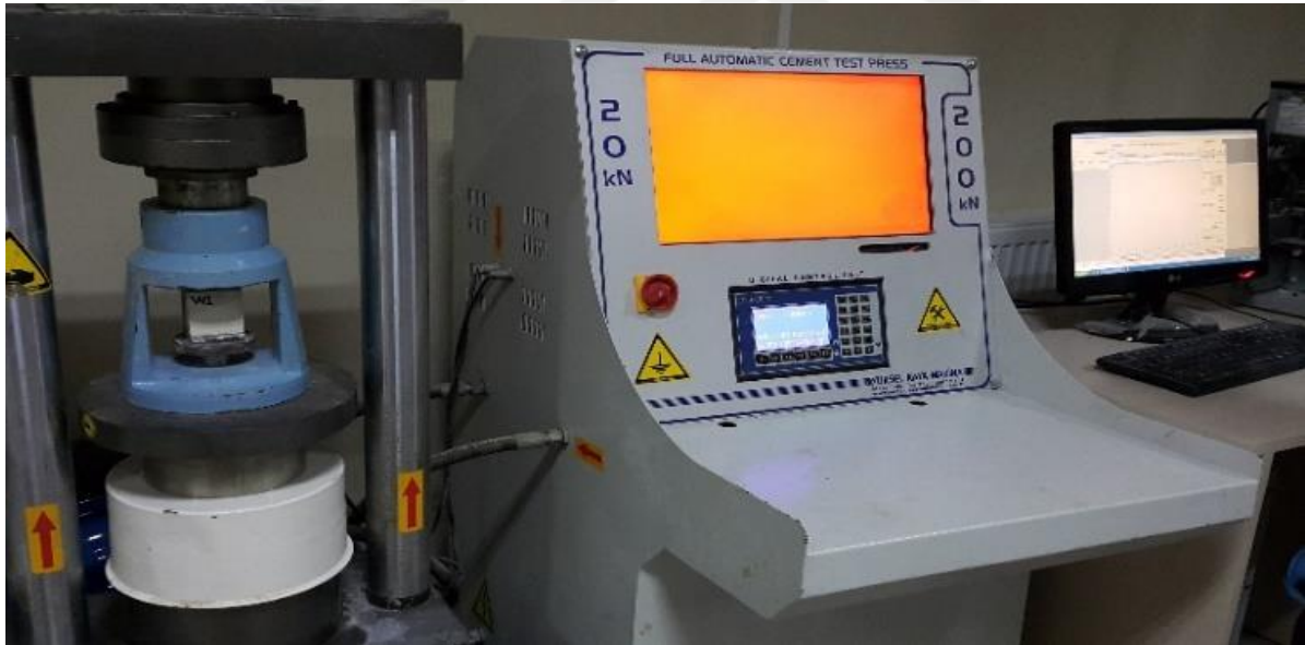
Şekil 19. Basınç dayanımı testi için kullanılan hidrolik pres.
