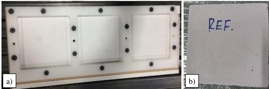
Şekil 17. a) Isıl iletkenlik testi numune üretmek için kullanılan kalıp, b) kalıptan çıkan numune.
