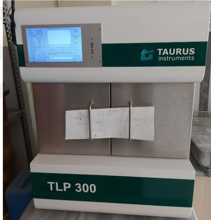
Şekil 14. Isıl iletkenlik ölçümleri için kullanılan TLP 300 cihazı.
