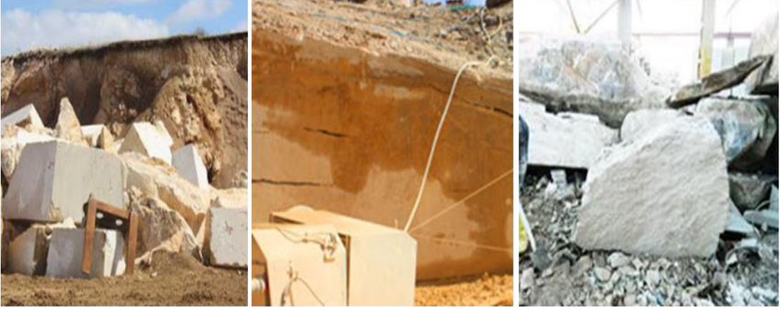
Şekil 8. Bayburt ili ocaklarından çıkan volkanik tuf blokları.
