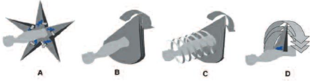
Şekil 2.6. YART teknikleri şematik gösterimi (A) sabit gantri YART, (B) kesit-kesit fan demet ışınlama, (C) Tomoterapi ve (D) kon demet YART (8)
