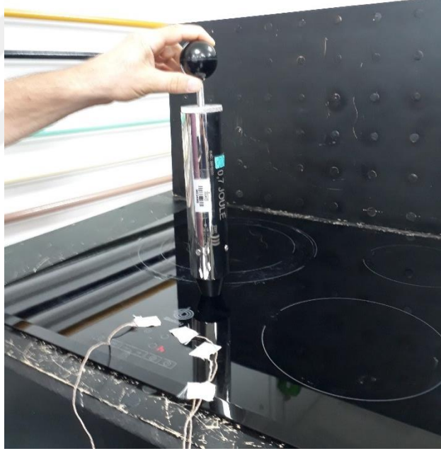
Şekil 1.6 Yaylı çekiç parçası (Kişisel arşiv,2019)
