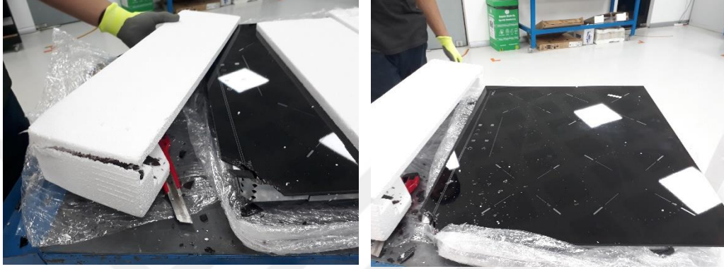
Şekil 4.40 VTC ocağın köşe atışı sonrası gözlemlenen hasar (Kişisel arşiv, 2019)
