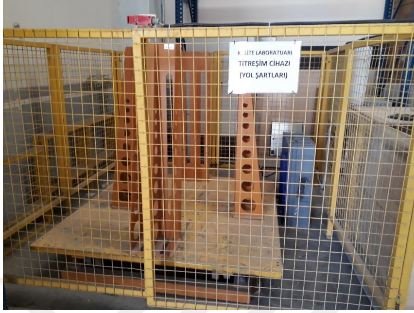
Şekil 1.10 Yol Testi Cihazı (Kişisel arşiv, 2019)
