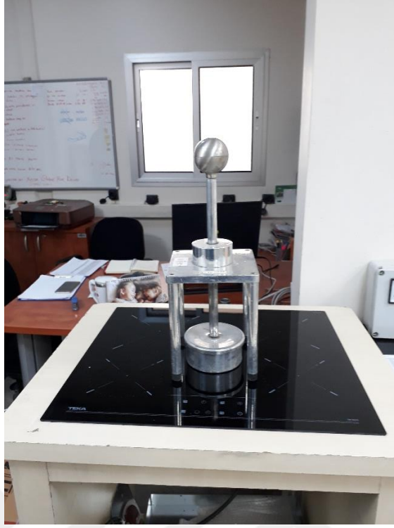
Şekil 1.9 Darbe Tava Test Aparatı (Kişisel arşiv, 2019)
