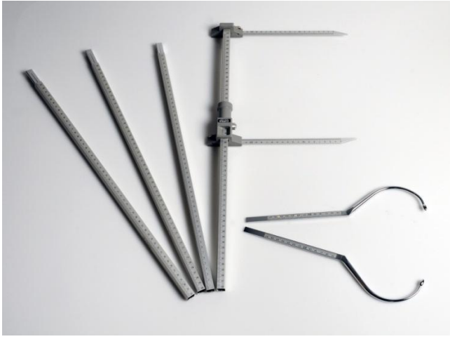
Şekil 3.8 Ölçüm işlemleri için kullanılan antropometre aleti
