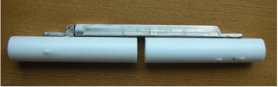
Şekil 25. Plak sisteminin teflon boru üzerine kırık hattı oluşturularak monte edilmesi.
