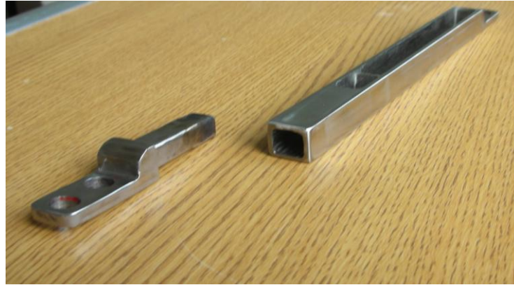
Şekil 23. 316L paslanmaz çelik malzemeden üretilen metal prototip.
