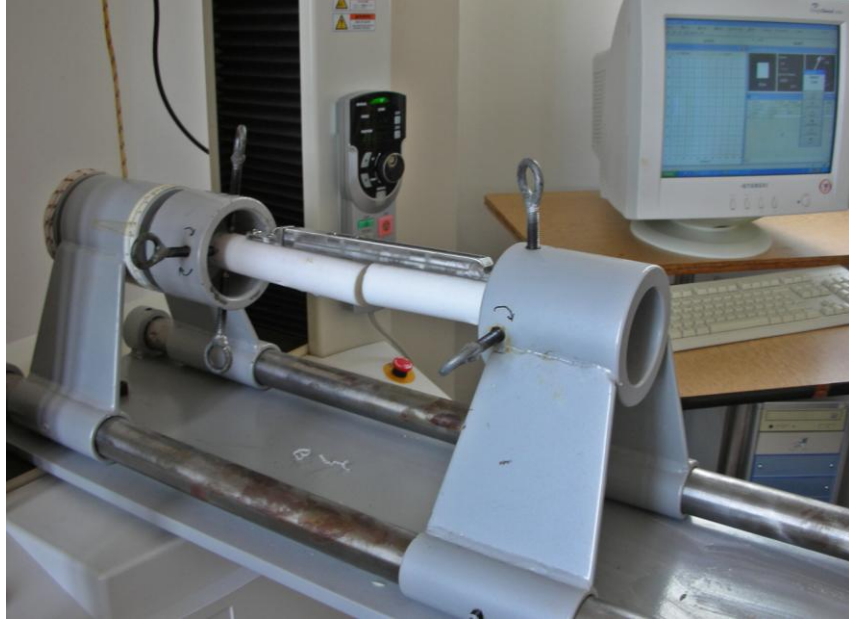
Şekil 28. Burulma (torsion) deneyi
