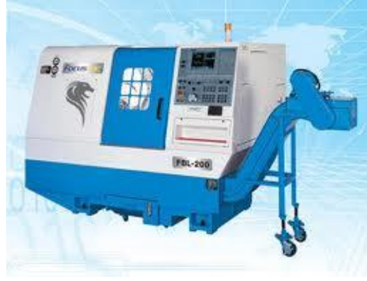
Şekil 22. Metal prototiplerin üretildiği Fanuc kontrol sistemine sahip Twinhorn Oi-mc CNC freze tezgahı ve Focus Oi-tc CNC torna tezgahı.
