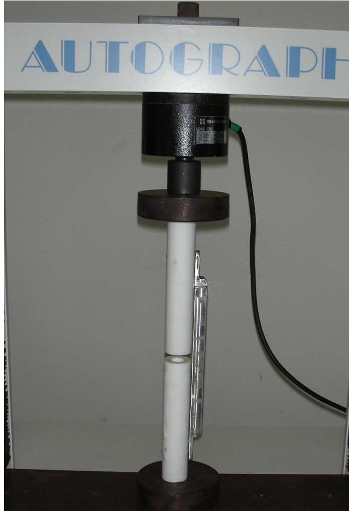
Şekil 27. Aksiyel yüklemde basma(compression) deneyi.
