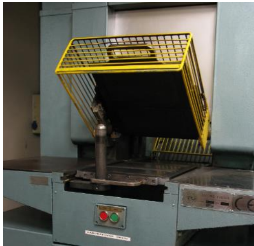
Şekil 3.15 : Test plakalarının hazırlandığı laboratuvar tipi pres
