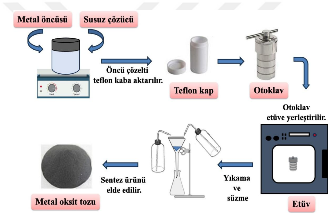
Şekil 2.14 : Solvothermal sentez yönteminde takip edilen deneysel akış (Bugalia ve Gupta, 2023).
