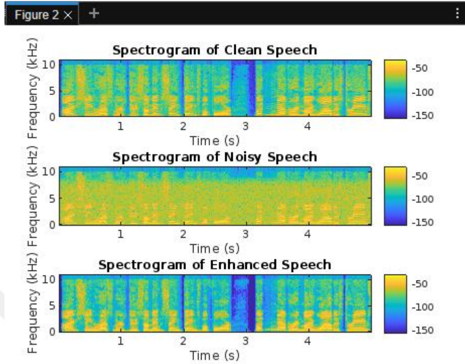
Şekil 5.3 Orijinal, gürültülü ve geliştirilmiş konuşmaların spektrogram karşılaştırmaları
