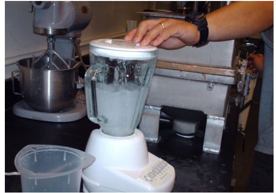
Fotoğraf 123. Karışıma su eklenmesi ve çırpıcıdan geçirilmesi. Doğal Kaynaklar Bölümü Laboratuvarı NCSU Raleigh ABD, 2011
