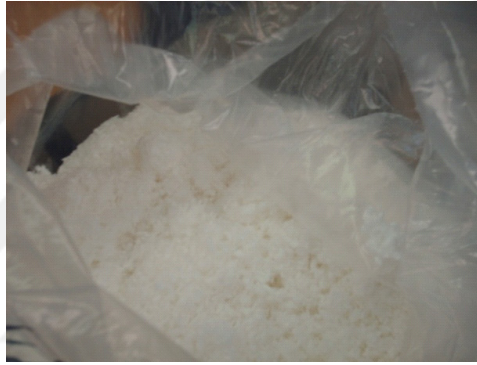
Fotoğraf 115. Ağartma işleminden sonra yumuşamış kâğıt hamurları. Doğal Kaynaklar Bölümü Atölyesi NCSU Raleigh ABD, 2011
