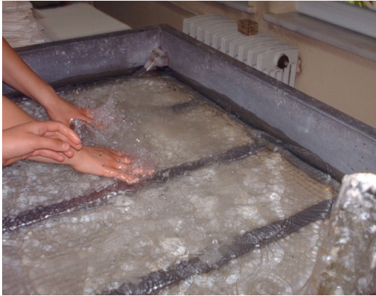
Fotoğraf 29. Kâğıt hamuru makinesi su suyun doldurma işlemi Konya Yazma Eserler Kütüphanesi, Restorasyon ve Cilt İşlemleri Bölümü, 2012
