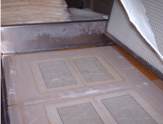
Fotoğraf 31. Delikli, eksik kısımların restorasyonunda kâğıt hamuru doldurma işleminin tamamlanması Konya Yazma Eserler Kütüphanesi, Restorasyon ve Cilt İşlemleri Bölümü, 2012
