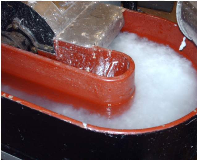
Fotoğraf 124. Hollander makinesinde karışımın ezilmesi Doğal Kaynaklar Bölümü Laboratuvarı NCSU Raleigh ABD, 2011
