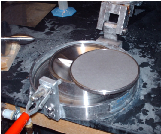
Fotoğraf 128. Suyun tahliyesinden metal süzgeçte kalan kâğıt. Doğal Kaynaklar Bölümü Laboratuvarı NCSU Raleigh, ABD, 2011
