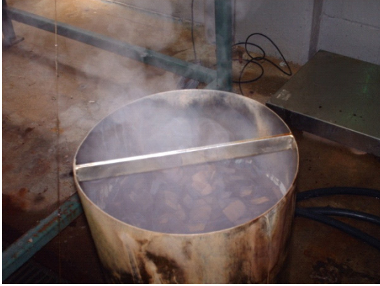
Fotoğraf 111. Pişirme sonrası cipslerin durumu Doğal Kaynaklar Bölümü Atölyesi NCSU Raleigh ABD, 2011
