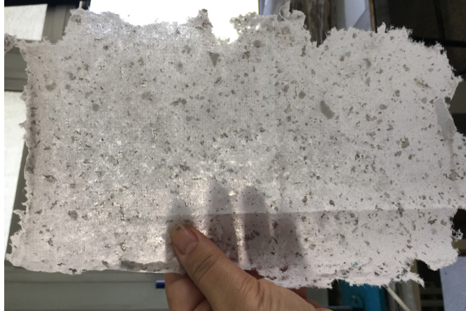
Fotoğraf 167. Kâğıt restorasyonunda kullanım amaçlı enginar liflerinden üretilmiş transparan kâğıt
