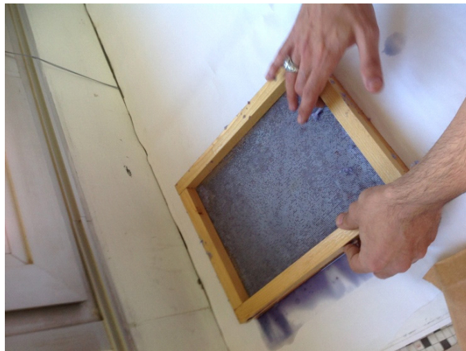
Fotoğraf 33. Western kâğıt yapımı tekniğinde kalıp
