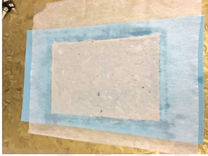
Fotoğraf 65. Kalıptan çıkarılmış telaya aktarılmış kâğıt hamuru
