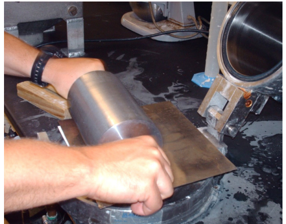
Fotoğraf 129. Metal levha üzerinde merdane ile kâğıdın düzleştirilmesi. Doğal Kaynaklar Bölümü Laboratuvarı NCSU Raleigh ABD, 2011
