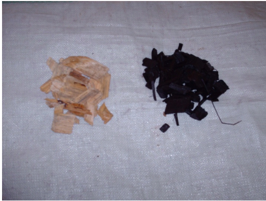
Fotoğraf 113. Odun parçacıkları pişirimden öncesi ve sonrası cipsler. Doğal Kaynaklar Bölümü Atölyesi NCSU Raleigh ABD, 2011
