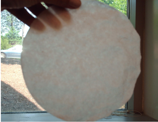
Fotoğraf 133. Laboratuar da üretilmiş transparan asitsiz kâğıt. Kâğıt Bilimi Doğal Kaynaklar Bölümü Laboratuvarı NCSU Raleigh ABD, 2011
