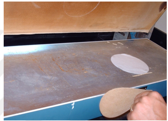
Fotoğraf 131. Kâğıtların sıcak preste düzleştirilmesi. Doğal Kaynaklar Bölümü Laboratuvarı NCSU Raleigh ABD, 2011
