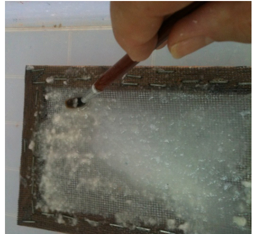
Fotoğraf 159. Kâğıt hamurunun kalıp üzerinde inceltilmesi
