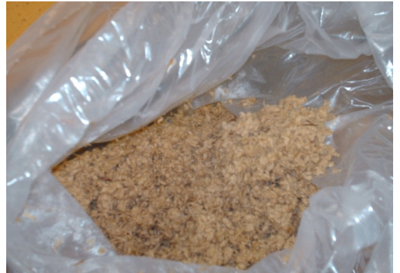
Fotoğraf 114. Ağartmasız pişirimden sonra yumuşamış odun parçacıkları (pulp) Doğal Kaynaklar Bölümü Atölyesi NCSU Raleigh ABD, 2011
