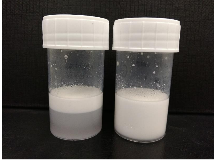
Şekil 14. Isıtılmamış ve ısıtılmış WPI tarafından stabilize edilmiş Y/S emülsiyonlarının hazırlandıktan birkaç saat sonraki hali
