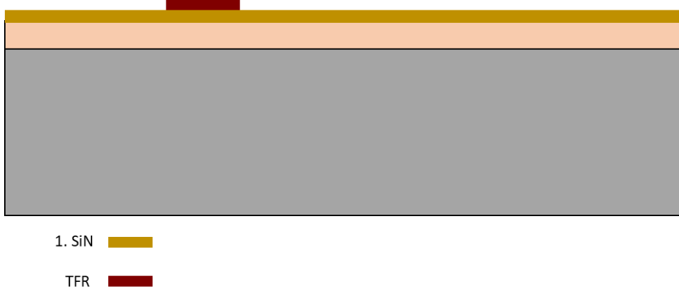
Şekil 2.19. TFR tabakasının süreç adımı sonrası wafer kesit görüntüsü
