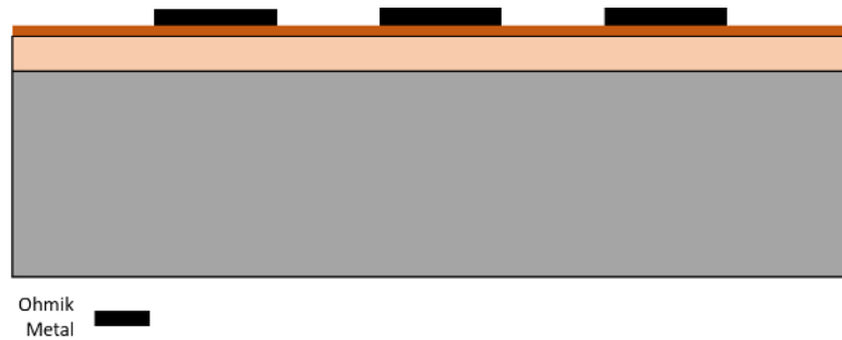
Şekil 2.3. Önyüz ohmik metal süreç adımı sonrası wafer kesit görüntüsü
