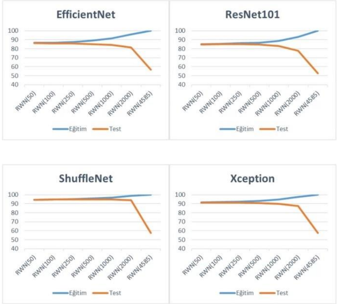
Şekil 4.6. RWN gizli katman nöron sayısının eğitim ve test başarısına etkisi
