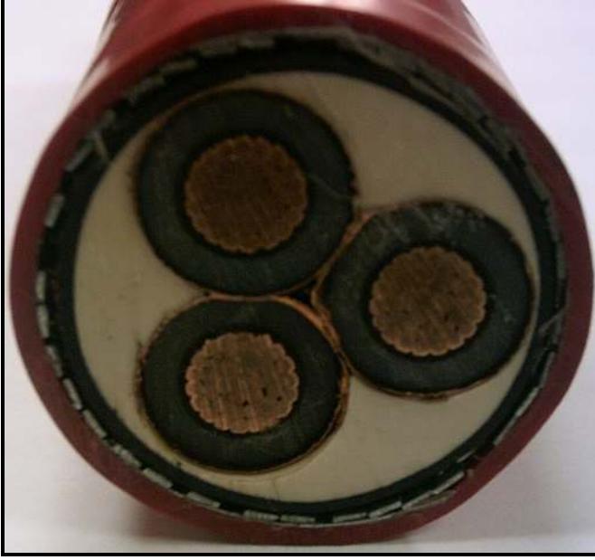
Resim 4.1. Üç damarlı, bakır siperli ve XLPE izoleli güç kablosu kesiti [Tamer EMRE arşivinden]
