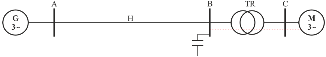
Şekil 2.13. Transformatörün B barasına kompanzasyon yapılan sistemler [39]
