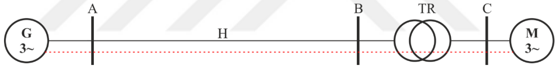
Şekil 2.11. Kompanzasyon yapılmayan sistemler [39]
