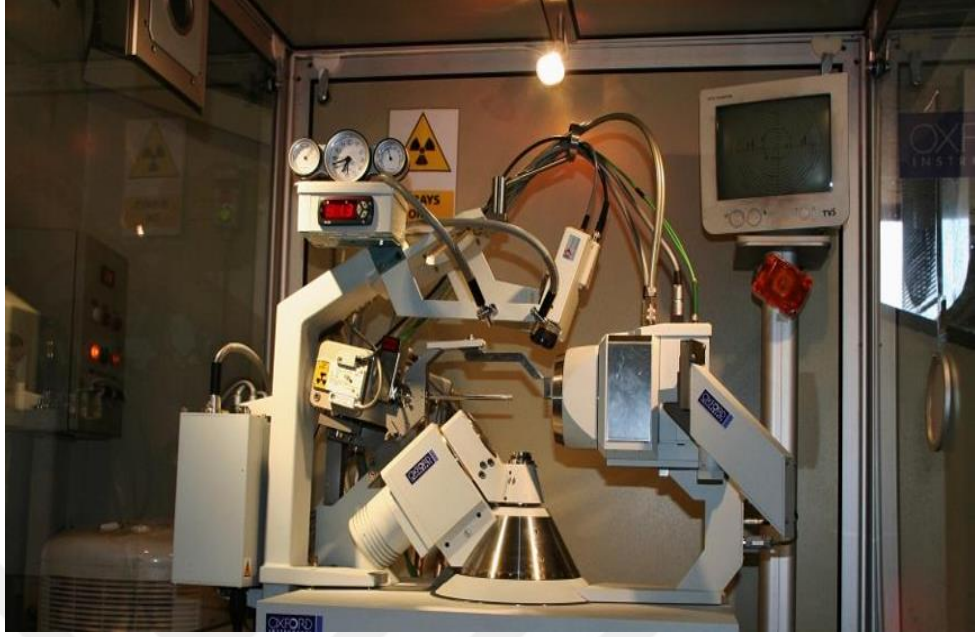
Şekil 3.4 Xcalibur Oxford CCD Difraktometre cihazı (Perugia Üniversitesi).
