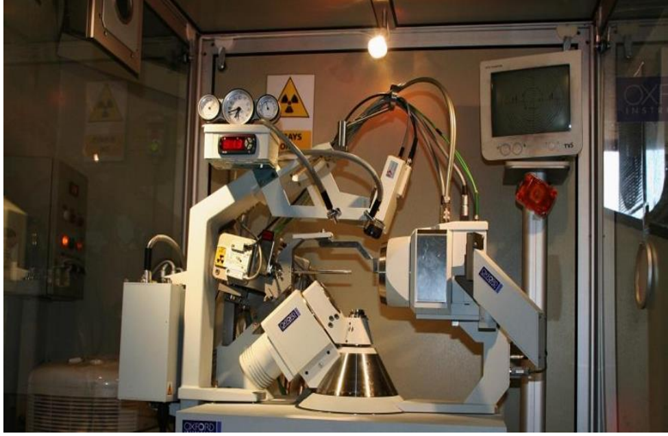
Şekil 3.4 Xcalibur Oxford CCD Difraktometre cihazı (Perugia Üniversitesi).
