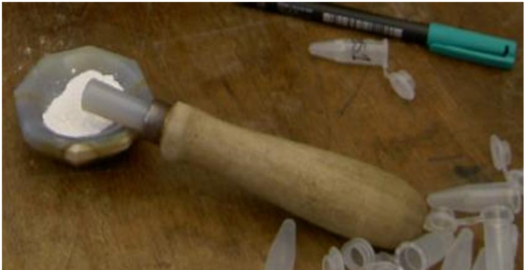
Şekil 3.3 XRD çekimi için hazırlanan, agat havanda öğütülmüş kayaç
