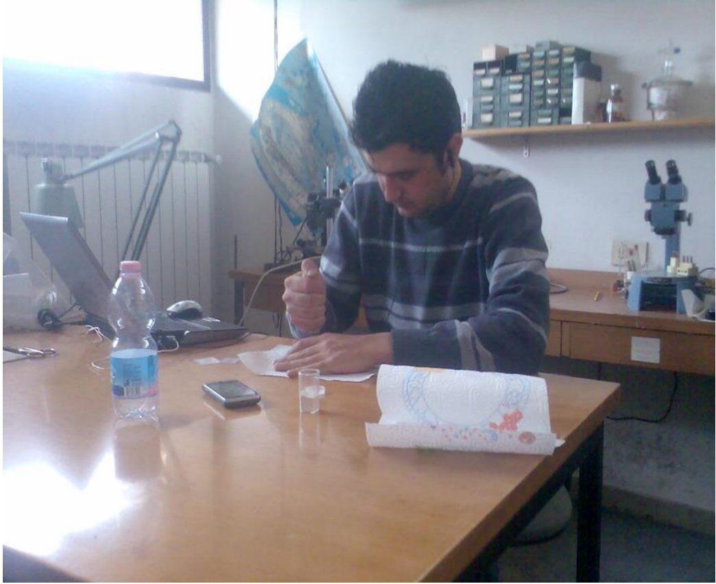
Şekil 3.2 Kayaç örneklerinin XRD çekimi için öğütülmesi.
