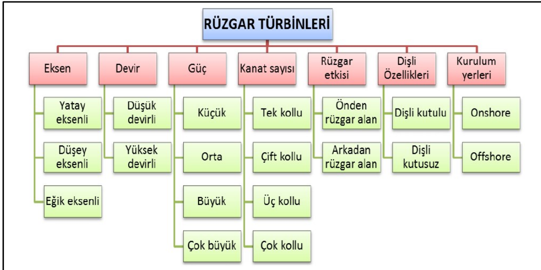
Şekil 2.3 Rüzgar türbinlerinin çeşitli kriterlere göre sınıflandırılması.
