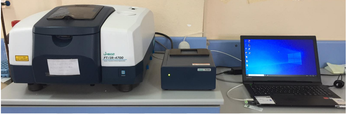
Şekil 3. 8. Jasco FT-IR-4700 fourier dönüşümlü kızılötesi spektrofotometresi
