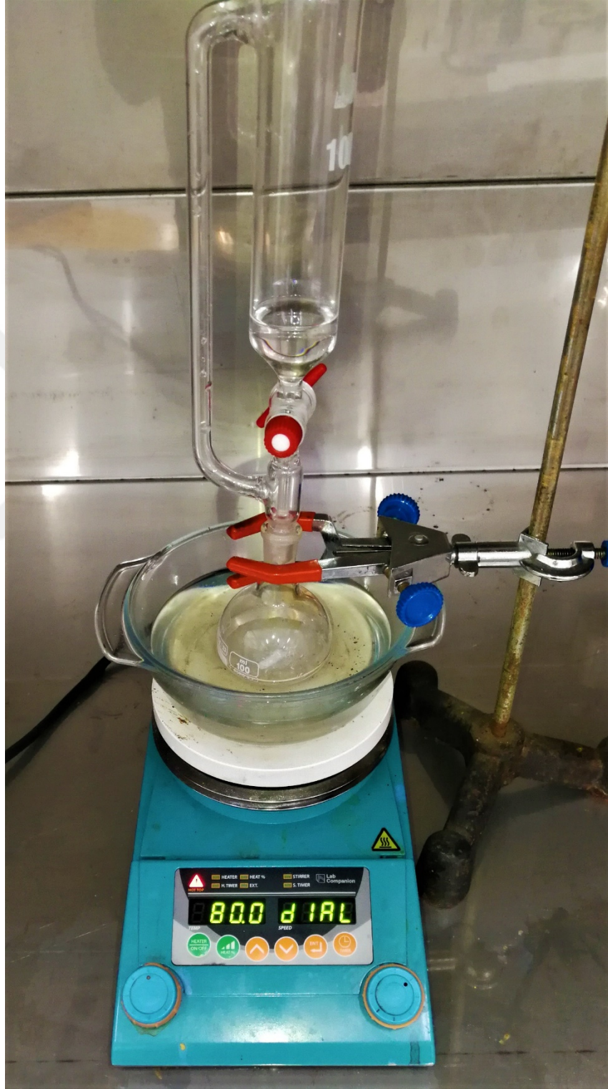
Şekil 3. 1. FDM’lerin sentezi için kullanılan reaksiyon düzeneği
