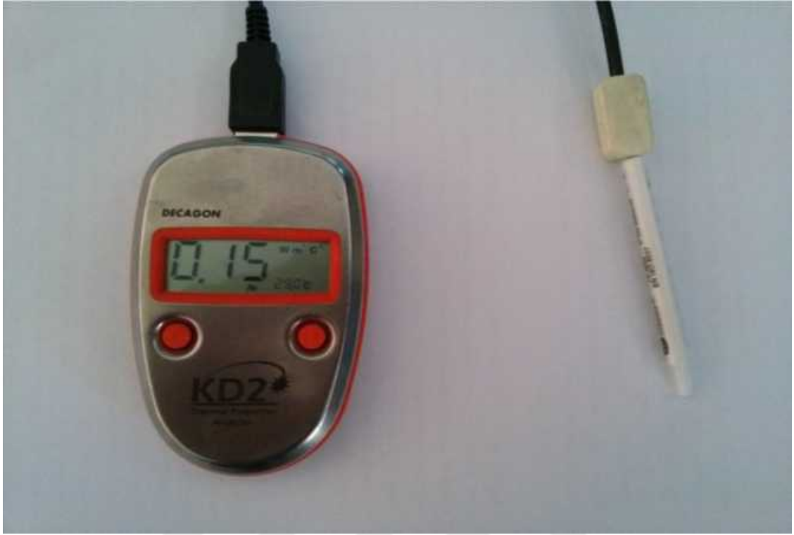
Şekil 3. 12. KD2 Pro ısı iletkenlik ölçüm cihazı
