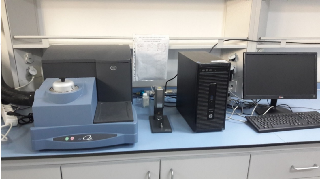
Şekil 3. 9. TA INSTRUMENTS Q20 DSC Cihazı (Amasya Üniversitesi Merkezi Araştırma Laboratuvarı Uygulama ve Araştırma Merkezi, Amasya)
