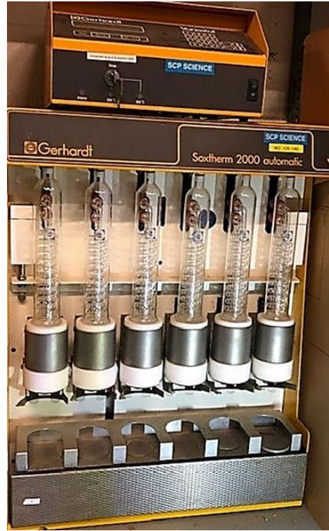
Şekil 3.5. Sokslet yağ tayin cihazı
