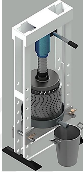
Şekil 1.52. Elle tahrik edilen hidrolik tip yağ çıkarma pres
