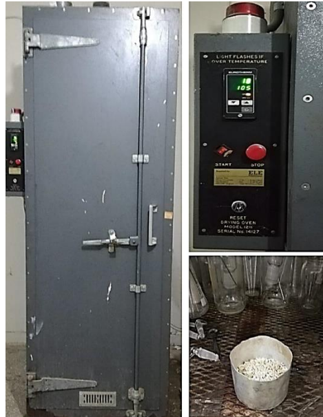
Şekil 3.8. Nem ve ekstraksiyon çözücüsünün uçurulması için kullanılan etüv
