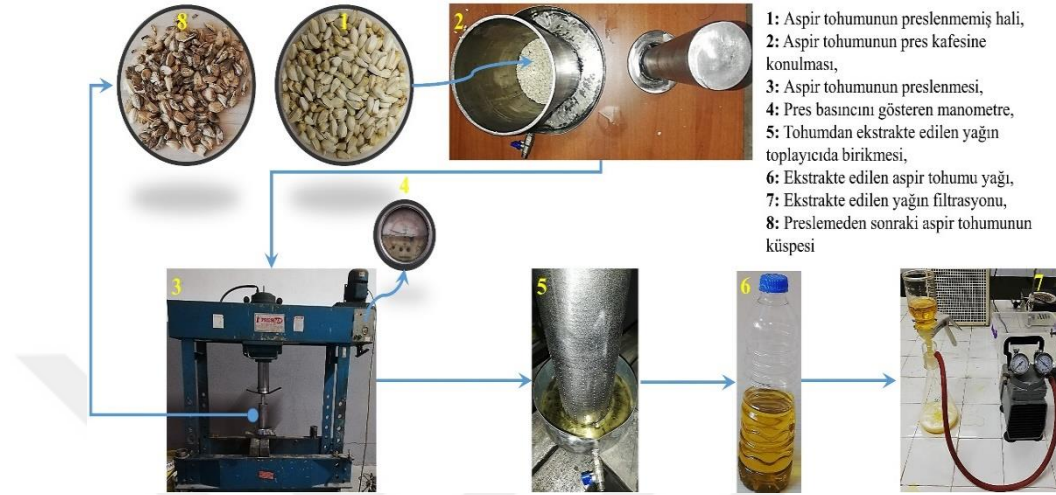
Şekil 3.47. Hidrolik pres ile aspir tohumundan yağın ekstraksiyonu
