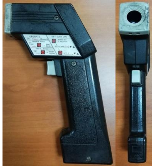
Şekil 3.39. Egzoz gazı sıcaklığı ölçümünde kullanılan kızılötesi termometre
