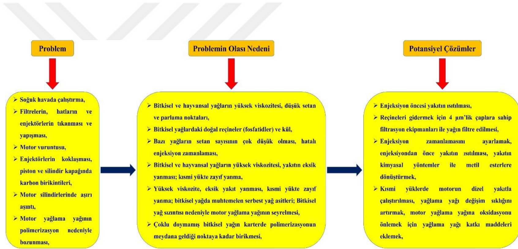
Şekil 1.32. Yağların yakıt olarak kullanılmasına ilişkin sorunlar ve olası çözümler
