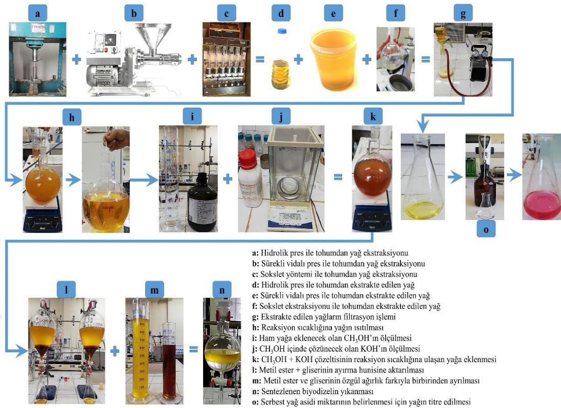
Şekil 3.55. Metil ester üretim aşamaları
