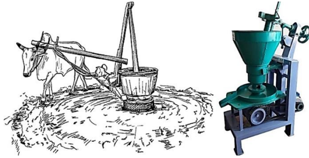
Şekil 1.53. Bir hayvan ve elektrik motoru tarafından tahrik edilen ghani sistemleri
