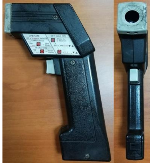
Şekil 3.39. Egzoz gazı sıcaklığı ölçümünde kullanılan kızılötesi termometre
