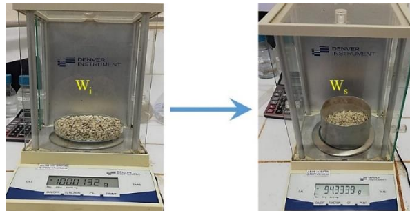
Şekil 3.43. Etüvde bekletilmeden ve 72 saat bekletildikten sonraki tohum kütlesi
