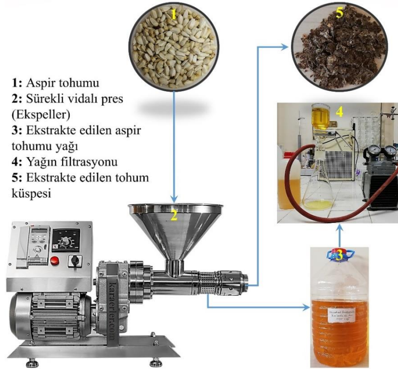
Şekil 3.48. Vidalı pres ile aspir tohumundan yağ ekstraksiyonu
