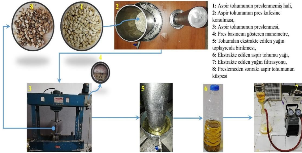
Şekil 3.47. Hidrolik pres ile aspir tohumundan yağ ekstraksiyonu
