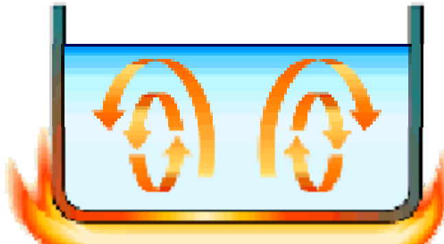
Şekil 5.4. Konveksiyon ısı transfer mekanizması
