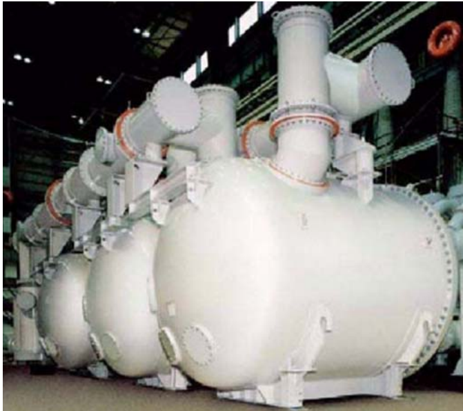
Resim 1.2. Gaz izoleli yüksek basınç transformatör
