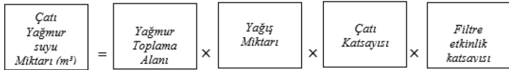
Şekil 3.3 Yağmur suyu hesaplamasında kullanılan Denklem (3.1)’in akış şeması
