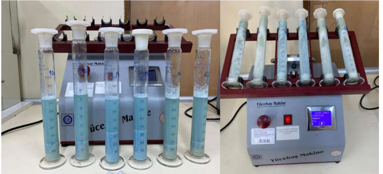
Şekil 10. Beklemeli sedimentasyon tayini
