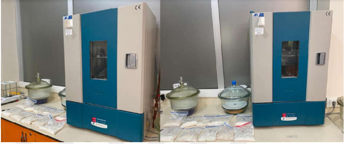
Şekil 1. Rutubet analizi amacıyla etüvde kurutma işlemi
