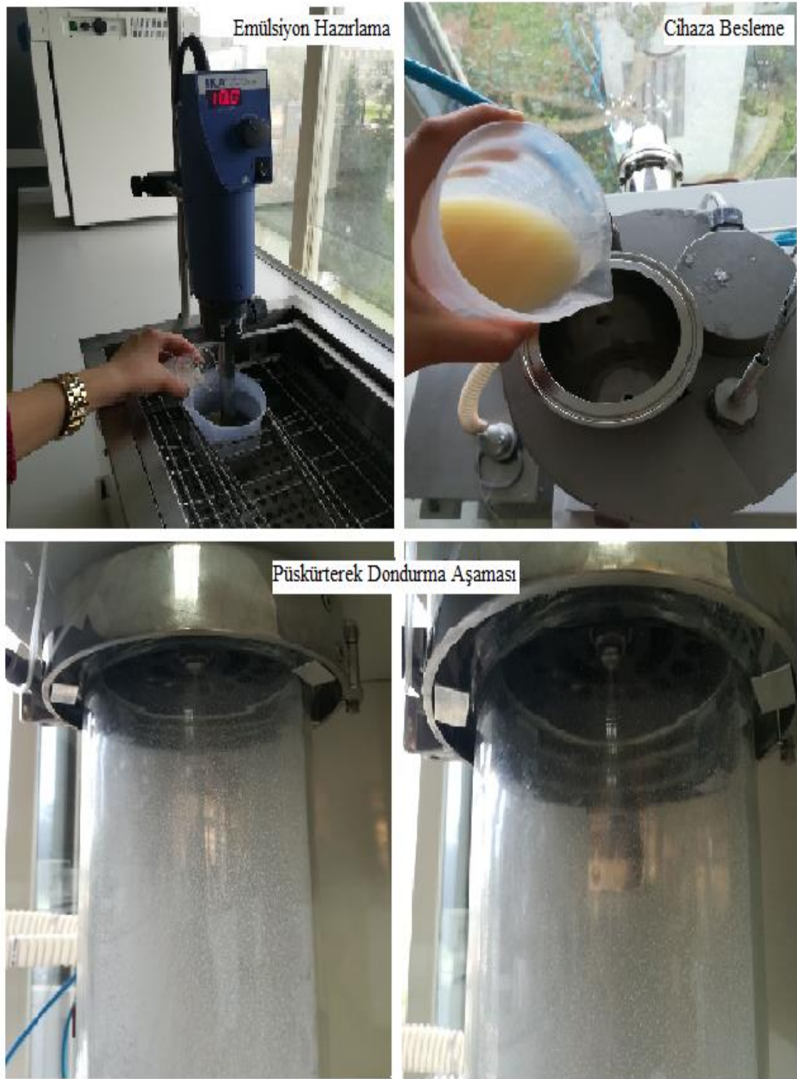
Şekil 3.2. Püskürterek soğutma cihazı ile kapsaisin mikroenkapsülasyonu aşamaları
