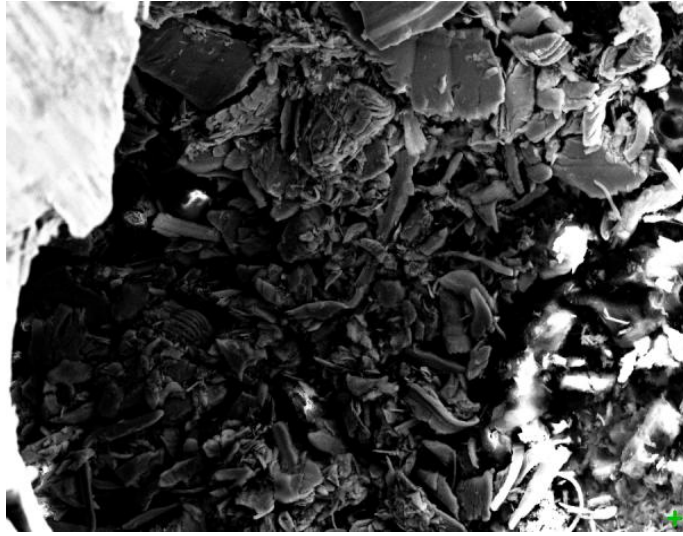
Şekil 4.15. % 90 dizel ve % 10 jet - al karışımı yakıt ile çalıştırılan enjektör kanalındaki EDX analizi yapılan yüzey.
