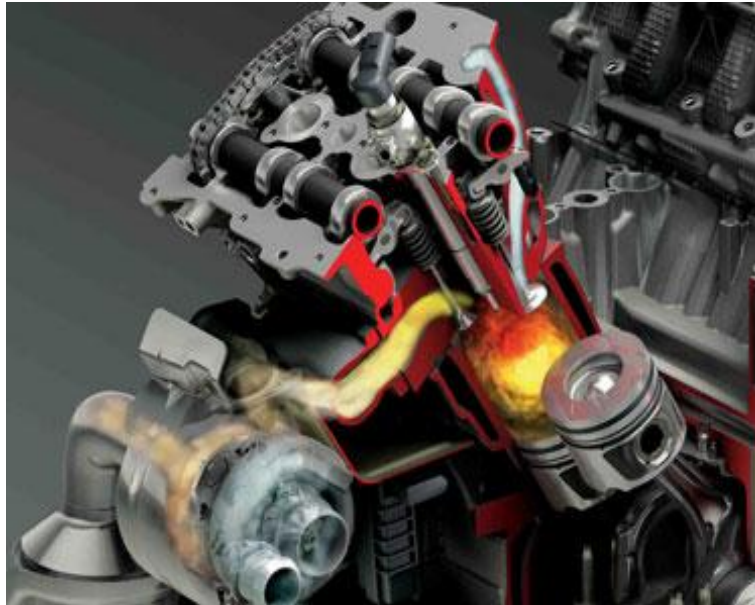
Şekil 2.1. Dizel motor piston içi ve yanma olayı (S.Buruk ve U.Özçelik,2007).
