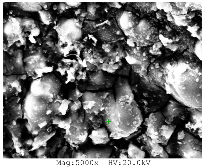
Şekil 4.20. % 90 dizel ve % 10 jet - al karışımı yakıt ile çalıştırılan enjektör kanalındaki EDX analizi yapılan yüzey.
