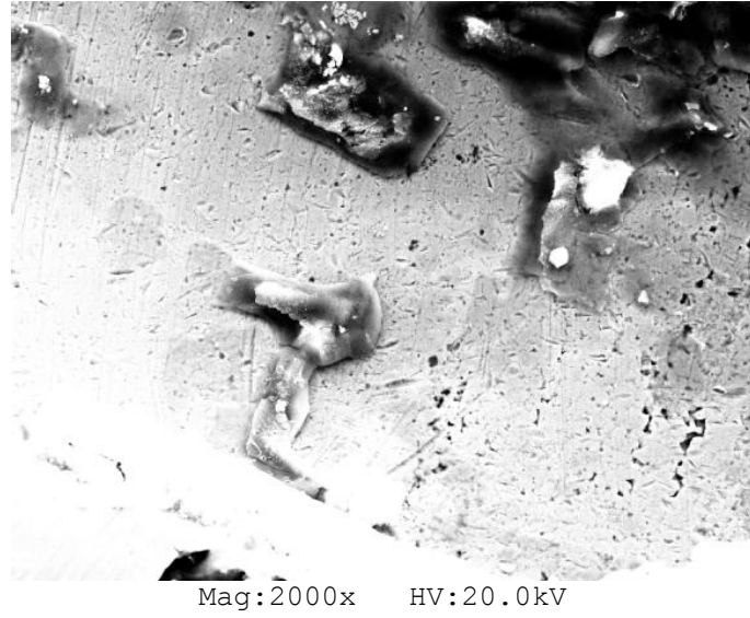
Şekil 4.6. Dizel yakıt ile çalıştırılan enjektör kanalındaki EDX analizi yapılan yüzey.
