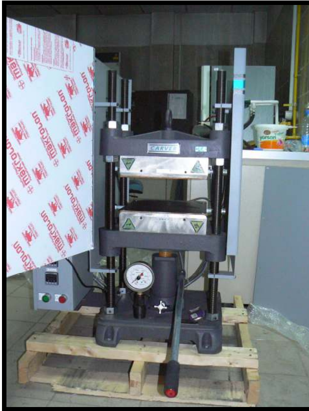
Resim 2.1. Sıkıştırma ile kalıplama için kullanılan sıcak presin görüntüsü
