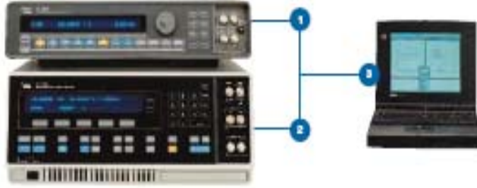
Resim 4.3. Solartron 1287 1260 kombinasyonu ve ölçüm hücresi. 1: 1287 ve 2:1260 [61].
