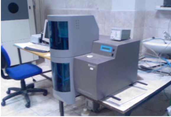
Resim 4.4. Setaram TGA+DSC cihazı.
