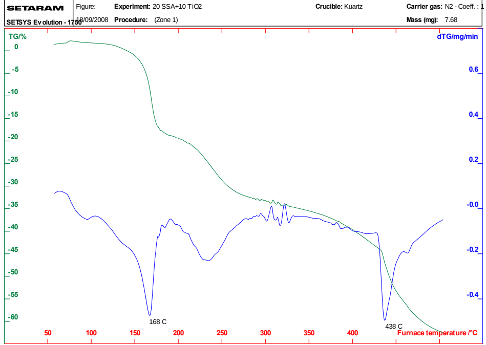
Şekil 2.5. 20SSA/5PEG/10TiO 2 katkılı membranları için TGA+DSG analizleri.
