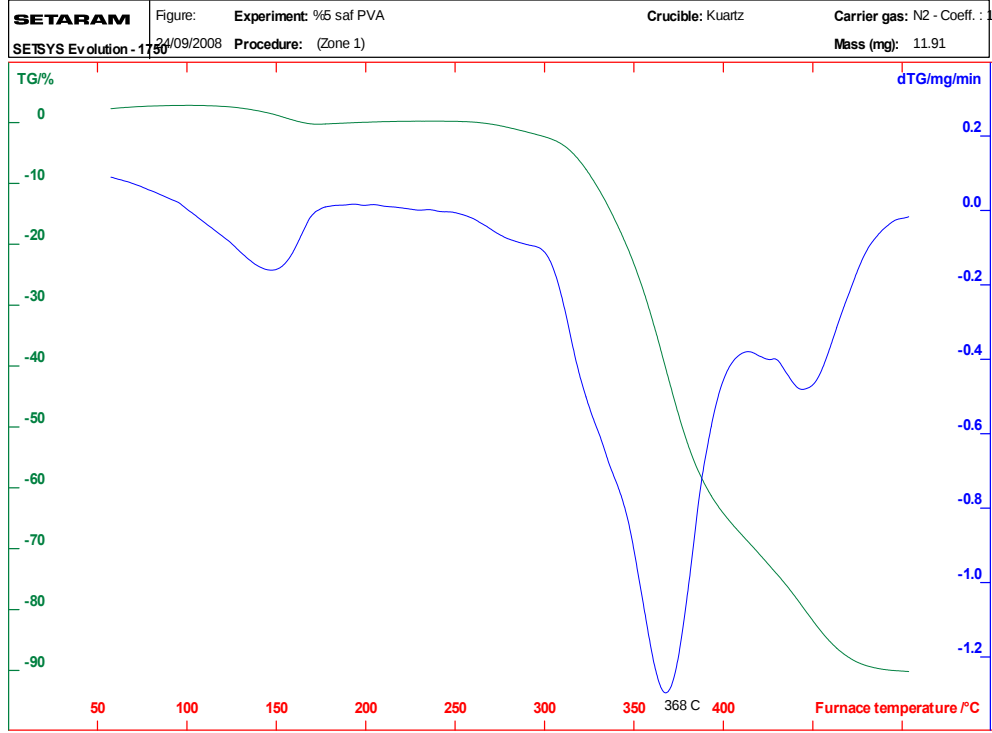
Şekil 2.7. Saf PVA membranı için TGA+DSG analizleri.
