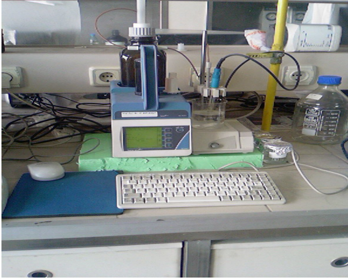
Resim 4.2. Shott TA500 plus titrasyon cihazı.
