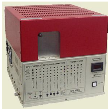
Resim 4.1. Reformer egsoz gazlarının analizinde kullanılan SRI 310C model GC cihazı
