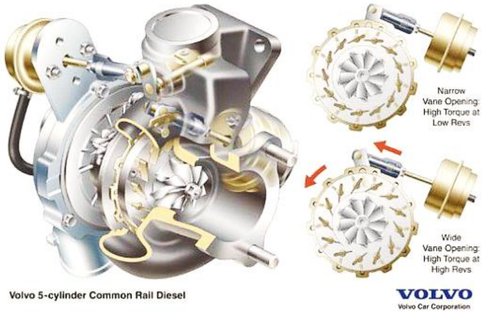
Şekil 3. 4 Volvo Markasının 5 Silindirli Dizel Motorlar İçin Ürettiği Turbo ve Çalışma Prensibi
