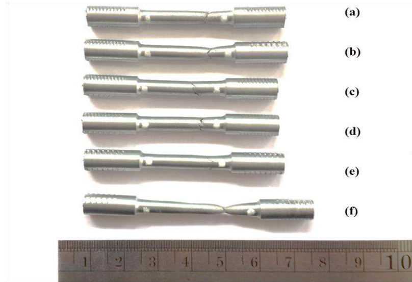
Şekil 15. (a) dökülmüş, (b) 0,5 h, (c) 1 h, (d) 2 h, (e) 3 h ve (f) 10 h yaşlandırılmış durumlarda çekme deneyine tabi tutulan Zn-27Al-1Cu alaşıımın boylarındaki değişimini gösteren fotoğraf
