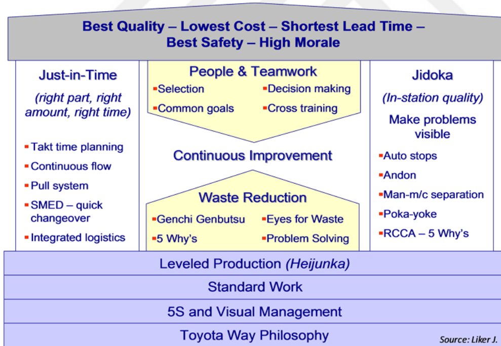
Şekil 1.1. Toyota Üretim Sistemi [20]
