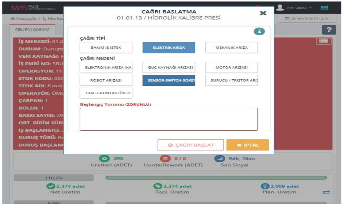
Şekil 3.36. Andon Sistemi Elektrik Arızası Ekranı 4
