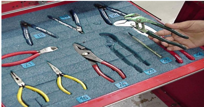
Şekil 3.7. Yanlış Yerleştirme Riskini Engellemeye Örnek
