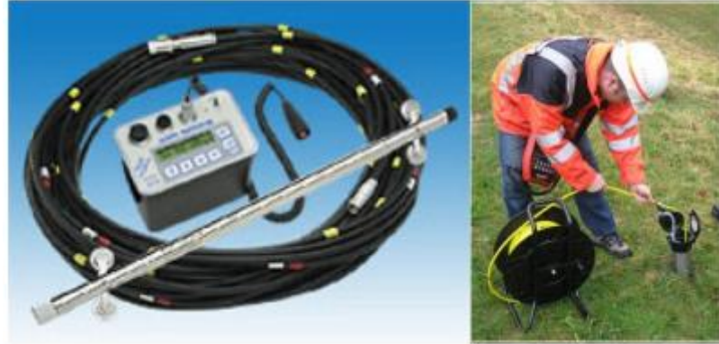
Şekil 5.3. İnklinometre aleti (Alçay, 2014).
