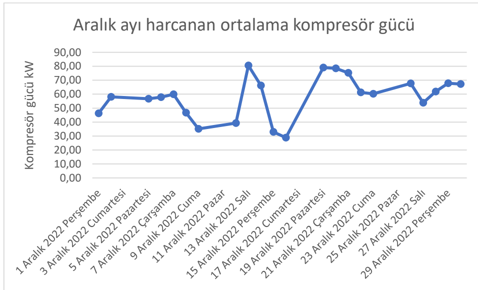
Şekil 3.19.Binada 2022 aralık ayında ısı pompasından harcanan kompresör gücü kW
