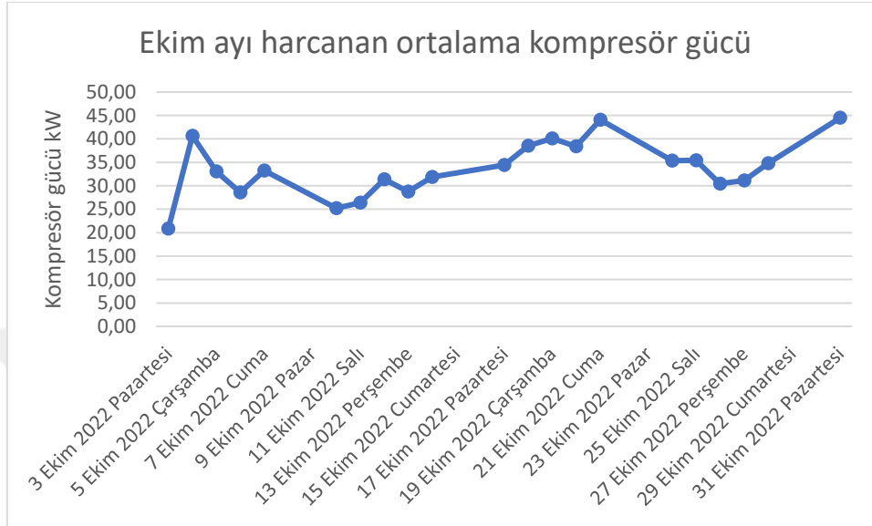
Şekil 3.17.Binada 2022 ekim ayında ısı pompasından harcanan kompresör gücü kW
