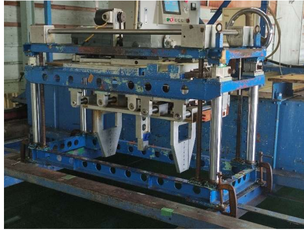
Şekil 4.5. Zorlayıcı yalpa mekanizmasının (a) şematik gösterimi (b) fotoğrafı
