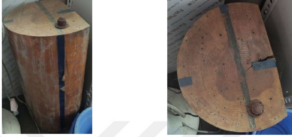
Şekil 2.6. Profesör Ikeda'nın çalışmasında kullandığı silindirik model
