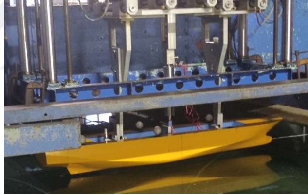
Şekil 4.6. Model ve mekanizmanın bağlantı resimleri
