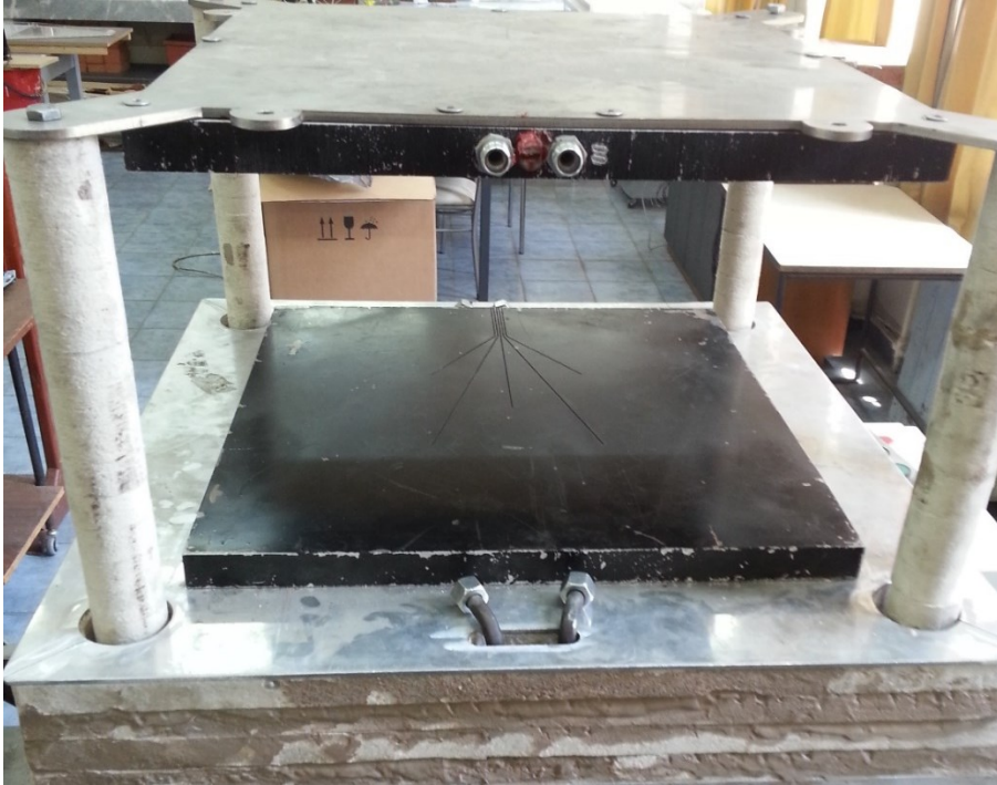
řekil 6.3 : Soğuk levha zerine termoelemanların yerleřtirilmesi.
