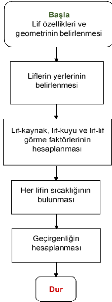
Şekil 4.5 : Monte Carlo Işın İzleme Yöntemi'nin akış şeması.
