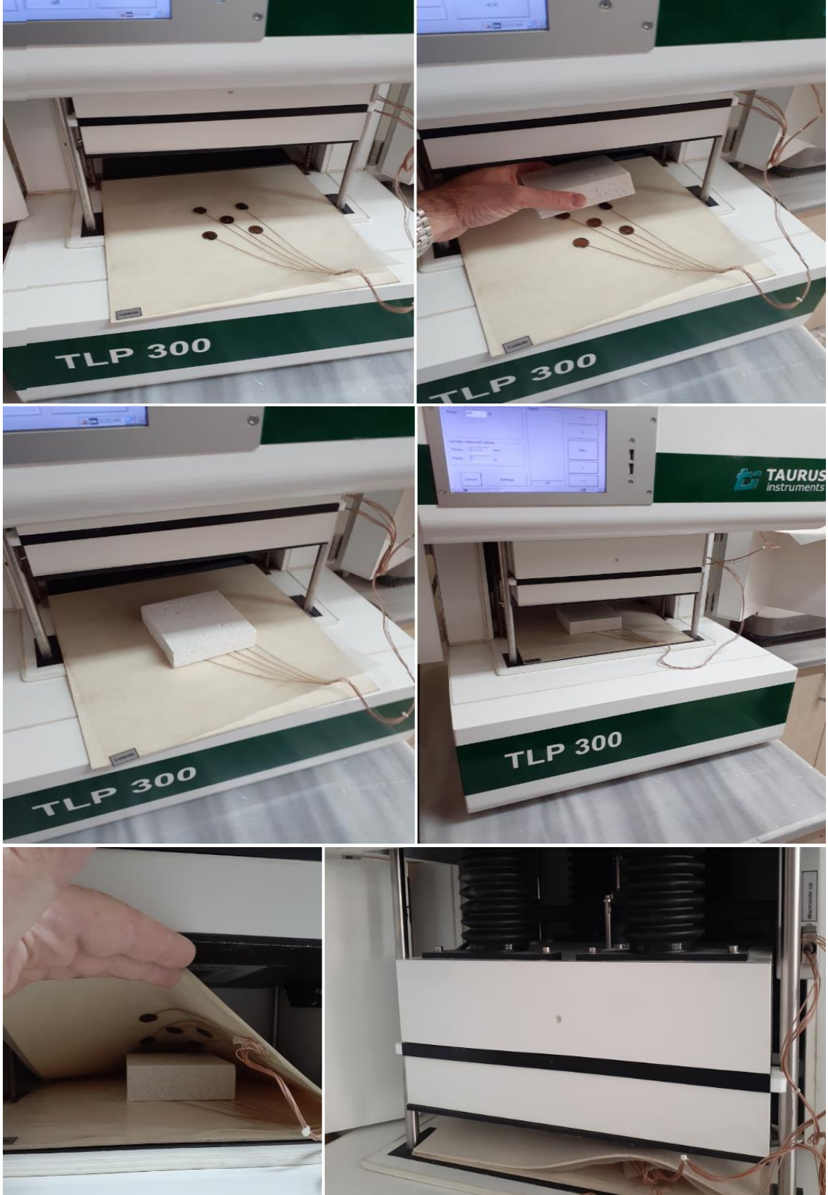
Şekil 3.10. Numune örneklerinin Taurus TLP 300 cihazına yerleştirilmesi ve ısı iletim katsayıları \lambda (lamda) değerlerinin tespiti
