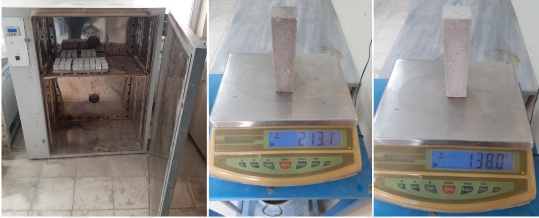
Şekil 3.18. Numunelerin etüvde kurutulması ve ağırlıklarının ölçülmesi
