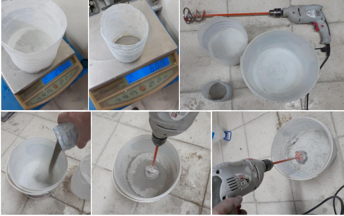
Şekil 3.4. Numune karışımlarının hazırlanışı
