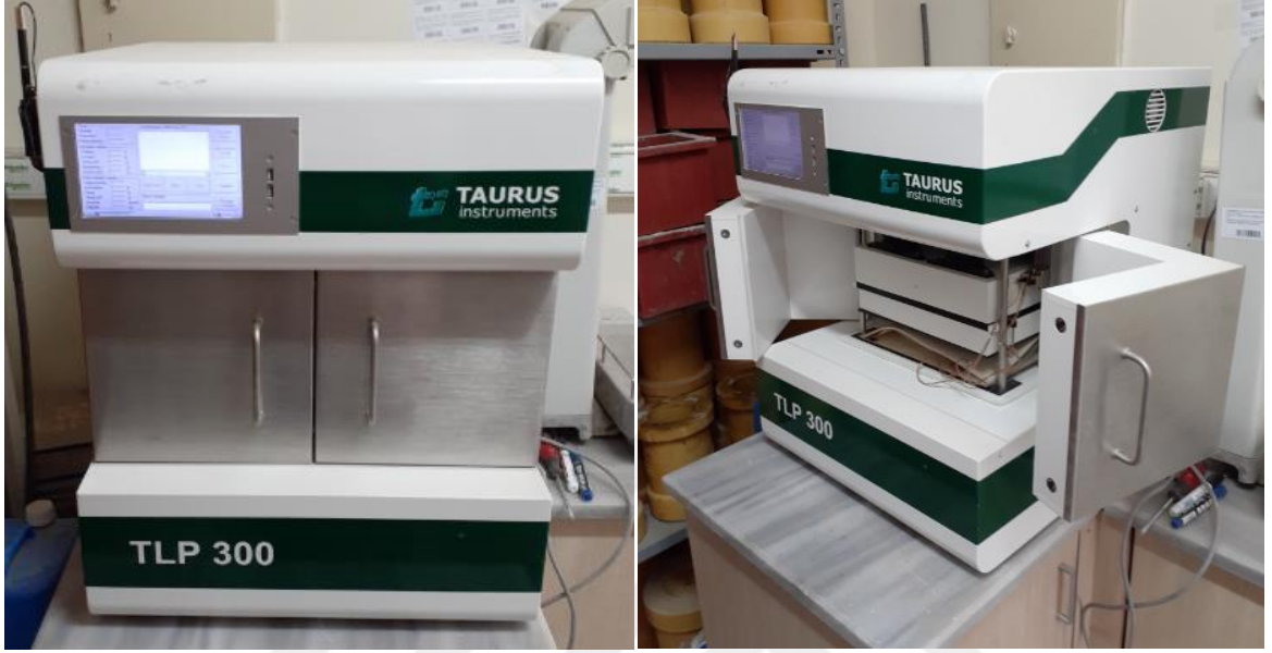
Şekil 3.6. Taurus TLP 300 Isı iletim katsayısı tespit cihazı
