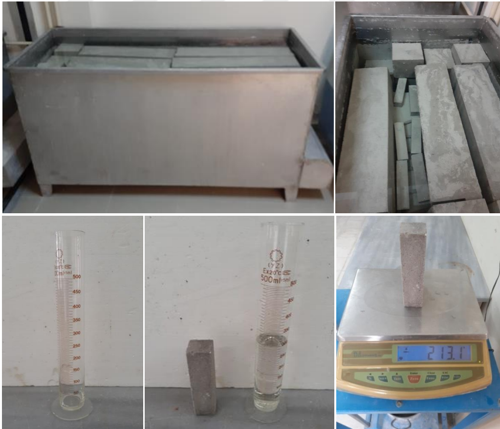
Şekil 3.17. Numuneleri havuzda bekletilmesi ve yoğunluk tayini
