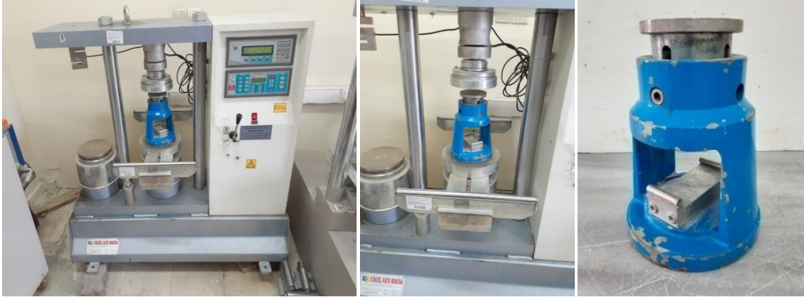
Şekil 3.13. Eğilme dayanım deneyi testinde kullanılan makine ve aparat
