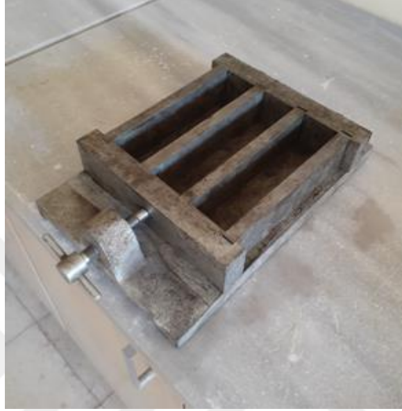
Şekil 3.11. Eğilme ve basınç deneyi için numune kalıbı
