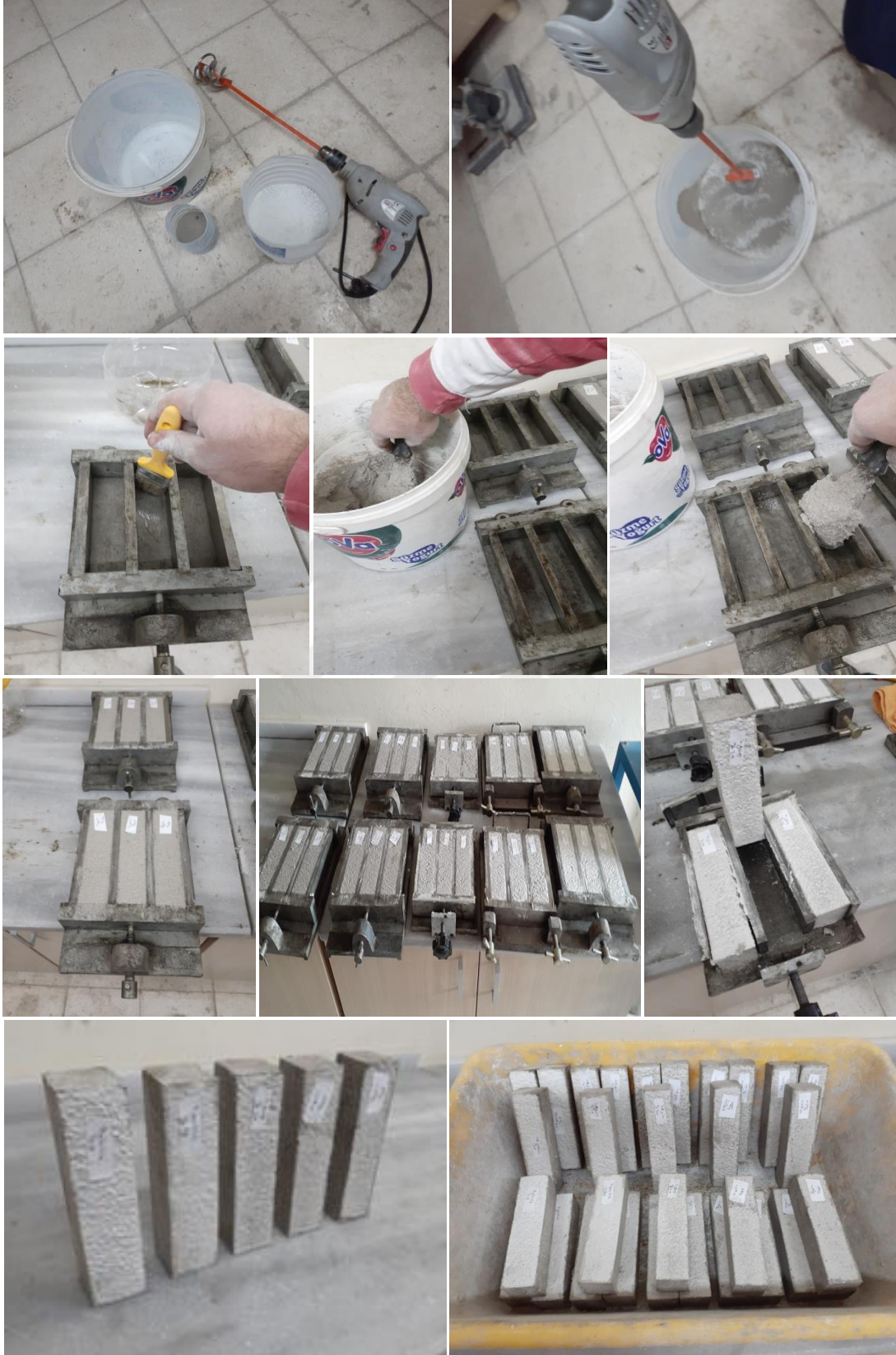
Şekil 3.12. Üretilen eğilme ve basınç deneyi numuneleri
