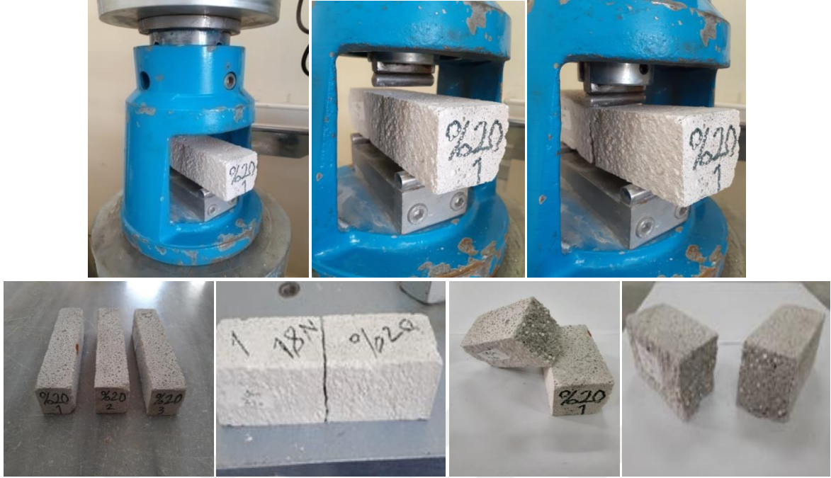
Şekil 3.14. Eğilme dayanım deneyinde kullanılan numunenin yük ile kırılması
