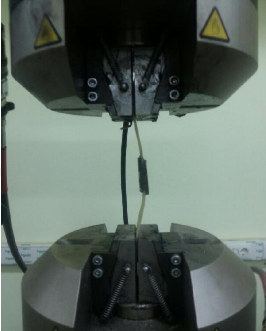
Şekil 5.6. Kritik burkulma yükünü geçtikten sonra burkulan malzeme
