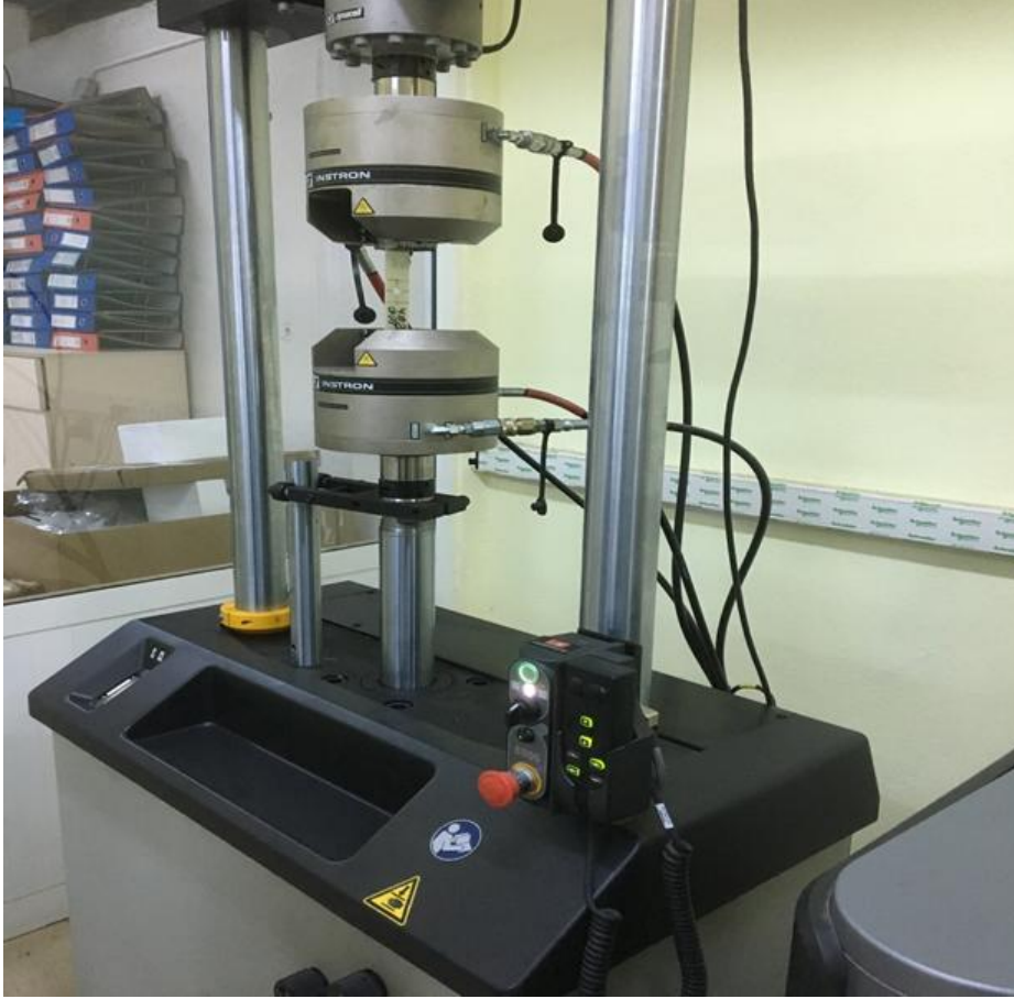
Şekil 4.13. Deney makinesi ve makineye bağlanmış numune
