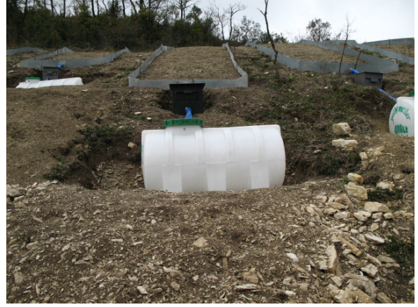
Şekil 2.9 Yüzeysel akış ve askıda sediment toplama tankı (Fotoğraf: Hüseyin Şensoy 2007).
