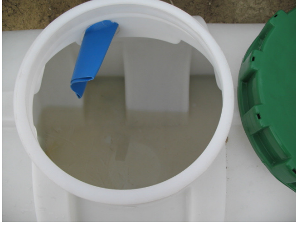
Şekil 2.9 Yüzeysel akış ve askıda sediment toplama tankı (Fotoğraf: Hüseyin Şensoy 2007).
