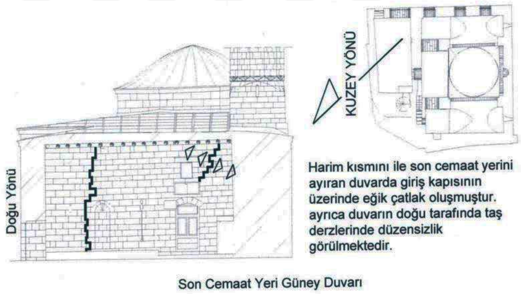
Şekil 2.4 (devam). Camide görülen hasarlar.
