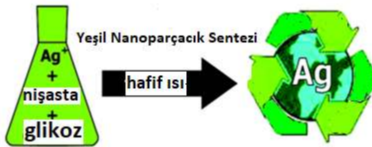
Şekil 2.13 Gümüş nanopartikülün yeşil sentezi (Raveendran 2003).
